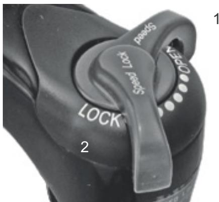
**Figura 55:** Regolatore della compressione Suntour con posizioni OPEN (1) e LOCK (2)
