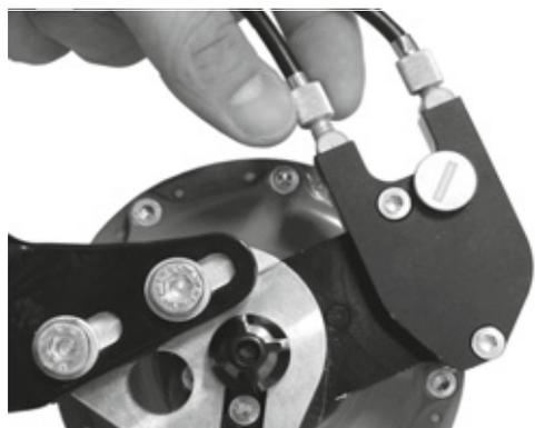
Illustration 162 : Sur les versions de moyeux ROHLOFF avec commande externe du changement de vitesse, le dispositif de réglage de la tension est situé sur le boîtier de câbles qui est placé sur le côté gauche.
