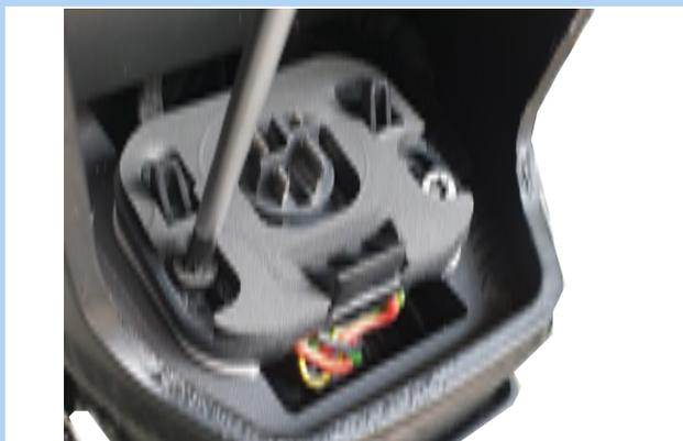
Illustration 48 : Desserrez les vis du logement de batterie
