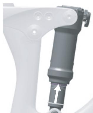
Illustration 113 : Déplacer le joint torique sur l'amortisseur arrière
