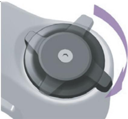
Illustration 244 : Régler le dispositif de réglage de la compression sur un niveau plus dur
