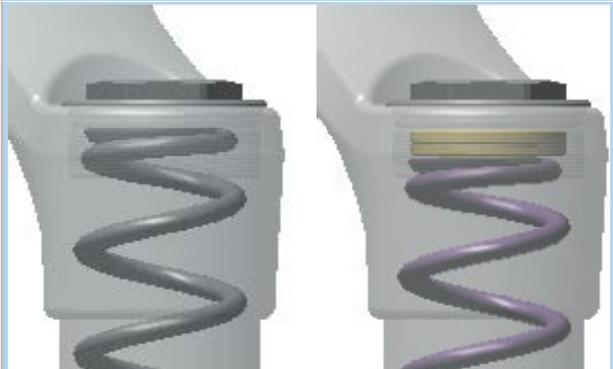
Illustration 111 : Serrer et desserrer l'anneau de réglage de la prétension
