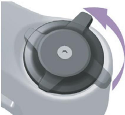
Illustration 246 : Régler le dispositif de réglage de la compression sur un niveau plus souple
