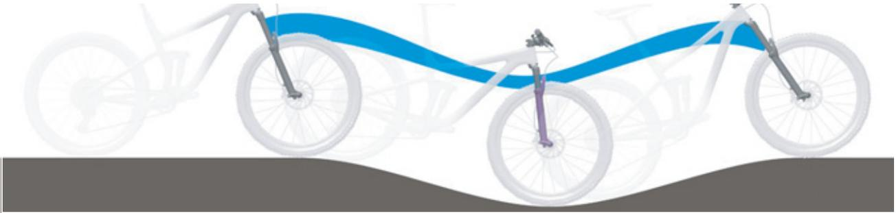
Illustration 243 : Suspension trop souple de la fourche suspendue dans les côtes
