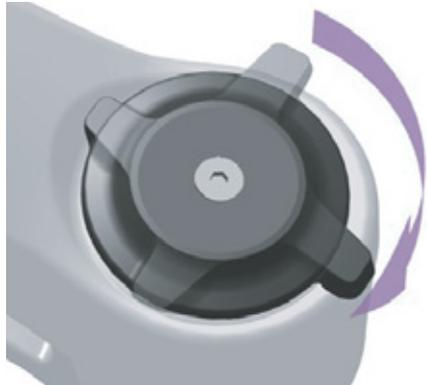
Illustration 147 : Régler le dispositif de réglage de la compression sur un niveau plus dur
