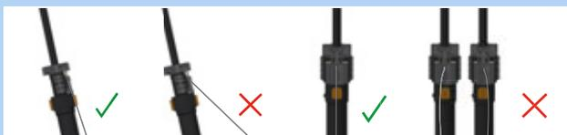
Illustration 196 : Câble Bowden correct et incorrect
