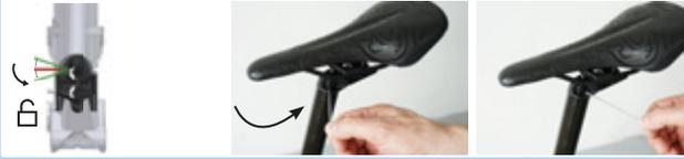
Illustration 169 : Placer le mécanisme de réglage de la hauteur en « position ouverte »
