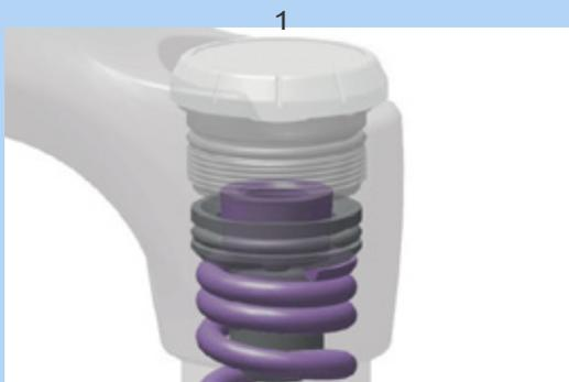
Illustration 102 : Serrer et desserrer l'anneau de réglage de la prétension
