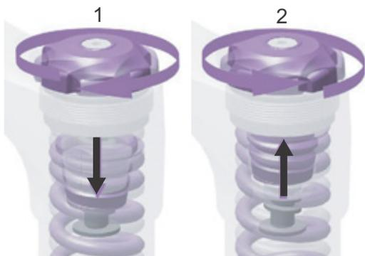
Illustration 104 : Serrer (1) et desserrer (2) l'anneau de réglage de la prétension
