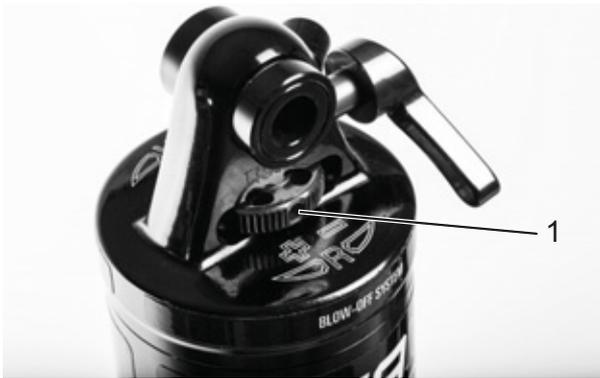
Illustration 248 : Molette de réglage de la détente Suntour (1) sur l'amortisseur arrière
