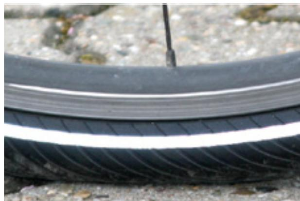
**Illustration 88 : Pression correcte. Le pneu se déforme à peine sous le poids du corps**
