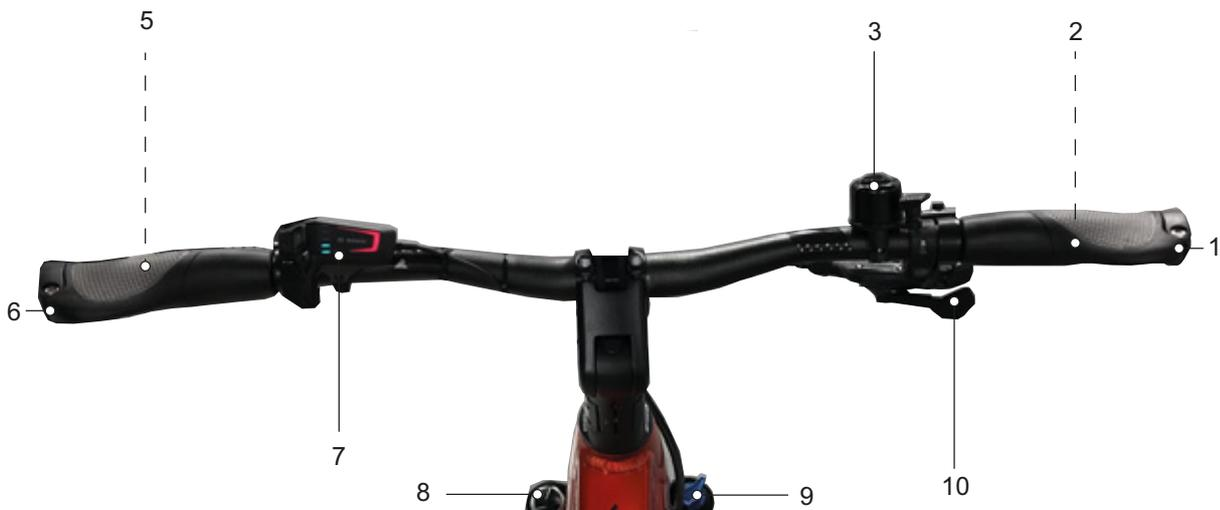
Illustration 42 : Vue détaillée d'un guidon avec BOSCH Kiox300, exemple
