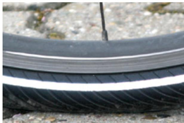
Illustration 94 : Pression correcte. Le pneu se déforme à peine sous le poids du corps
