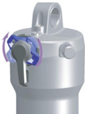
Illustration 123 : Régler le dispositif de réglage de la compression sur un niveau plus dur
