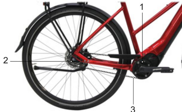
Illustration 36 : Schéma de l'entraînement à courroie
