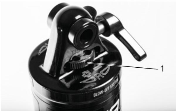
Illustration 250 : Molette de réglage de la détente Suntour (1) sur l'amortisseur arrière
