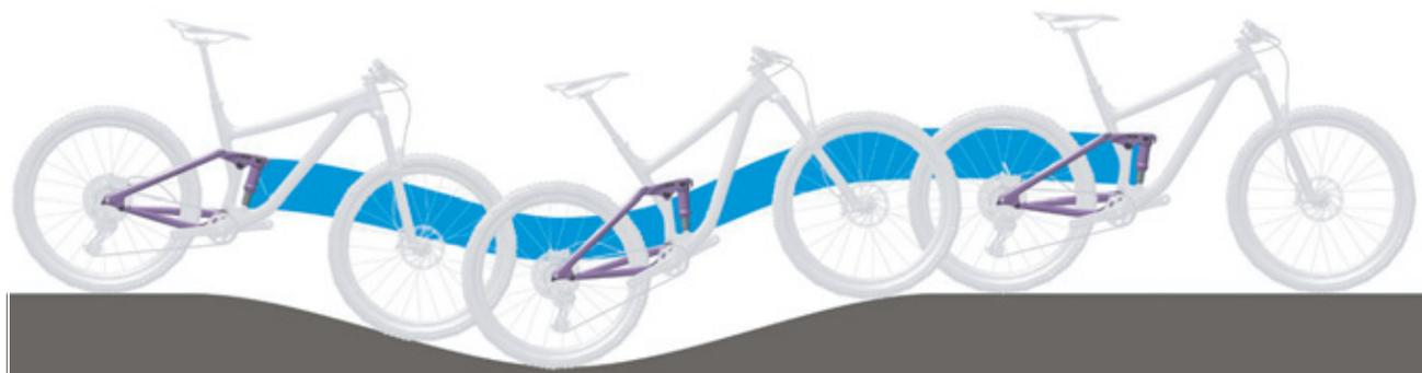
Illustration 21 : Comportement optimal de l'amortisseur arrière en terrain vallonné
