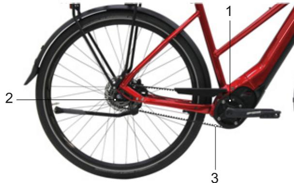
Illustration 33 : Schéma de l'entraînement à courroie
