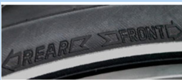
Illustration 60 : Flèche directionnelle sur les pneus VTT
