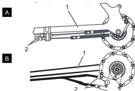
Illustration 140 : Douilles de réglage (2) sur deux modèles alternatifs (A et B) d'un changement de vitesse actionné par câble à deux câbles sur la base de cadre (1)
