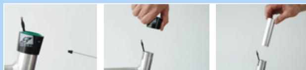
Illustration 187 : Démonter l'enveloppe extérieure et la douille de glissement
