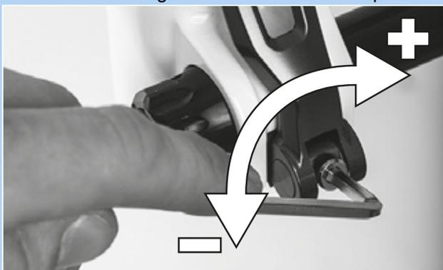
Illustration 143 : Régler la force de serrage de l'attache rapide
