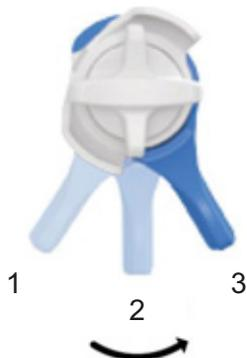
Illustration 97 : Réglage du levier à 3 positions : fermé (1), moyen (2) et ouvert (3)
