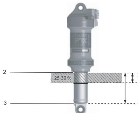
Illustration 98 : (1) Sag, joint en caoutchouc de la chambre d'air (2), joint torique et course de suspension totale de l'amortisseur
