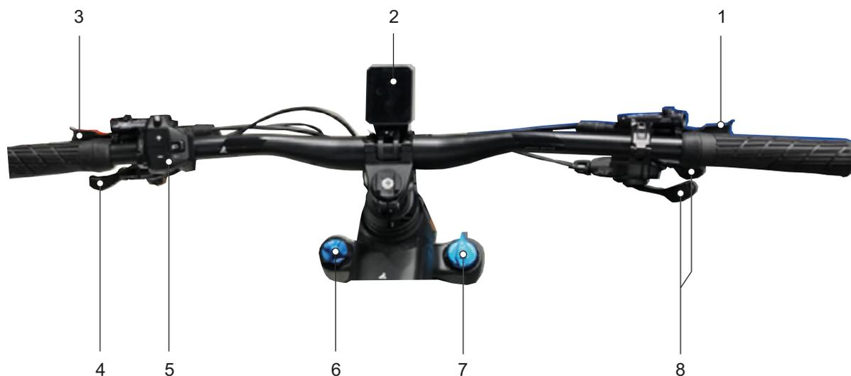
Illustration 38 : Vue détaillée d'un guidon avec ordinateur de bord SHIMANO SC-E800, exemple
