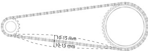
Illustration 136 : Contrôler la tension de la chaîne
