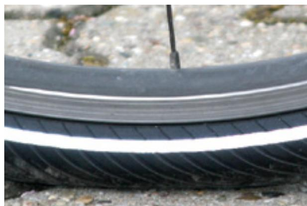
Illustration 83 : Pression correcte. Le pneu se déforme à peine sous le poids du corps
