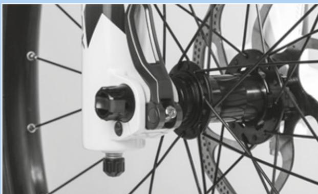
Illustration 142 : Régler la force de serrage de l'attache rapide
