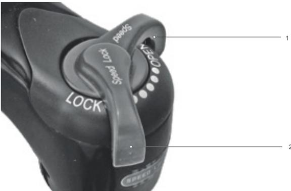
Illustration 214 : Régler le dispositif de réglage de la compression sur un niveau plus souple
