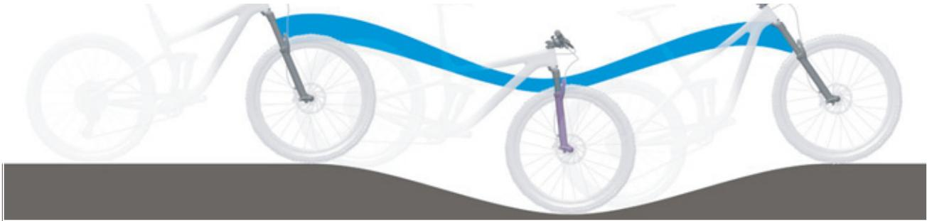
Illustration 219 : Suspension trop souple de la fourche suspendue dans les côtes
