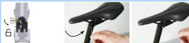
Illustration 145 : Placer le mécanisme de réglage de la hauteur en « position ouverte »
