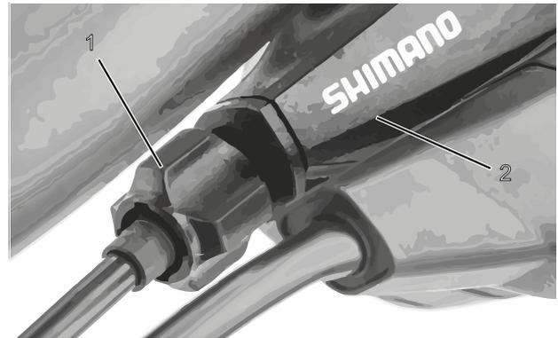
Illustration 139 : Douille de réglage (1) du changement de vitesse à un câble actionné par câble avec boîtier de manette de vitesse (2), exemple
