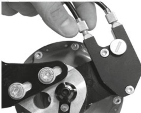
Illustration 138 : Sur les versions de moyeux ROHLOFF avec commande externe du changement de vitesse, le dispositif de réglage de la tension est situé sur le boîtier de câbles qui est placé sur le côté gauche.
