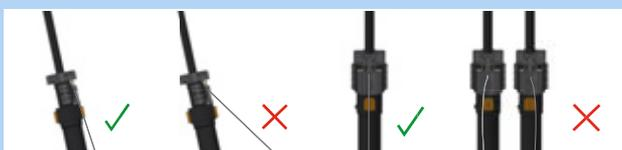
Illustration 172 : Câble Bowden correct et incorrect
