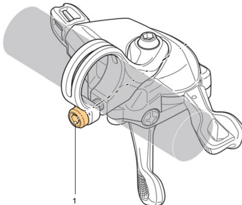
Illustration 89 : Position de la vis de fixation du levier de vitesse SHIMANO
