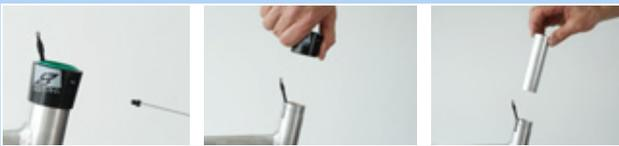
Illustration 153 : Démontez l'enveloppe extérieure et la douille de glissement
