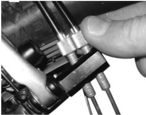
Illustration 137 : Sur les versions de moyeux ROHLOFF avec commande interne du changement de vitesse, le dispositif de réglage de la tension est situé sur le contre-support de tension.
