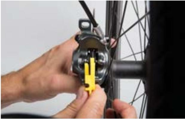
Illustration 134 : Contrôler la plaquette de frein montée à l'aide de la cale de transport
