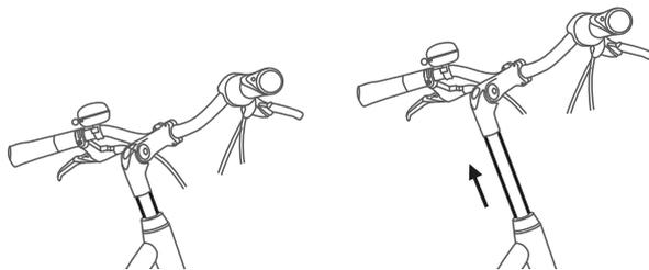
Illustration 78 : Régler la hauteur de la potence à plongeur
