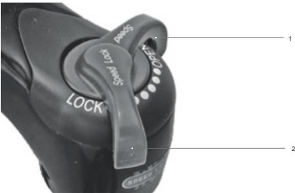
Illustration 212 : Régler le dispositif de réglage de la compression sur un niveau plus dur
