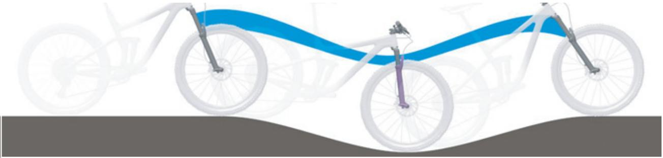
Illustration 211 : Suspension trop souple de la fourche suspendue dans les côtes
