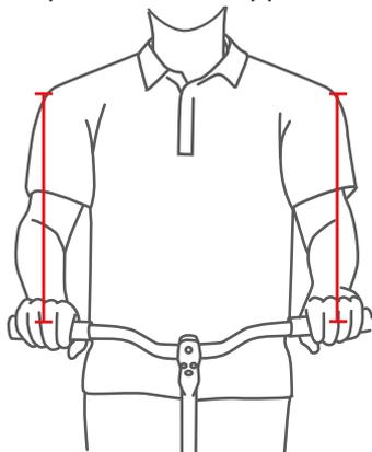
Illustration 74 : Déterminer la largeur optimale du guidon
