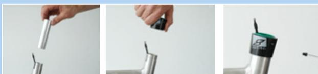
Illustration 169 : Monter la douille de glissement et l'enveloppe extérieure
