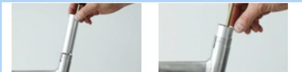
Illustration 176 : Insérer le tube de la douille de glissement dans le tube de selle
