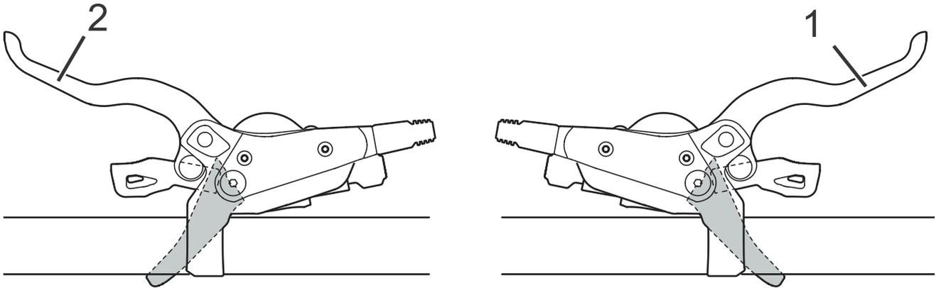
Illustration 55 : Freins à main arrière (1) et avant (2), exemple d'un frein SHIMANO
