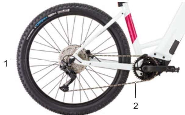
Illustration 32 : Schéma de l'entraînement à chaîne avec dérailleur
