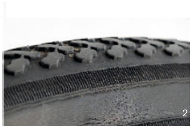
Illustration 133 : Exemples de fissures de fatigue (1) et de fissures d'âge (2)
