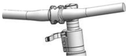
Illustration 109 : Exemple d'un All Up avec levier de serrage de la potence ouvert
