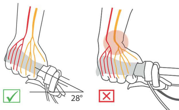
Illustration 75 : Disposition des nerfs avec guidon coudé et guidon droit
