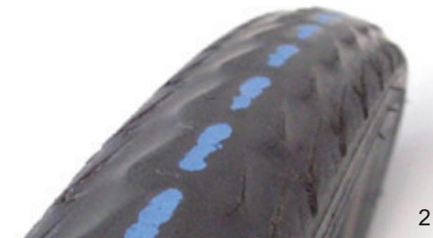
Illustration 132 : Pneu sans profil pouvant encore être utilisé (1) et pneu avec bande de protection visible (2) devant être changé
