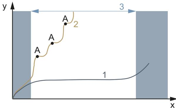
Illustration 128 : Diagramme d'usure, durée de service (x) par rapport à l'enlèvement de matière (y)
