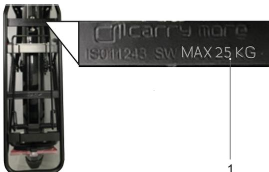
Illustration 112 : La capacité de charge maximale (1) est indiquée sur le porte-bagages.
