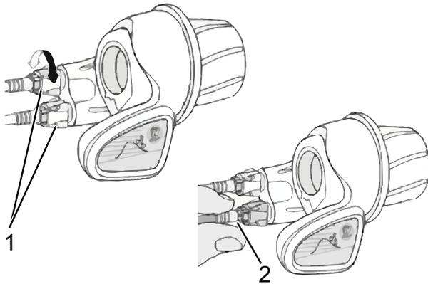
Illustration 141 : Poignée de vitesse rotative avec douilles de réglage (1) et jeu du changement de vitesse (2)
