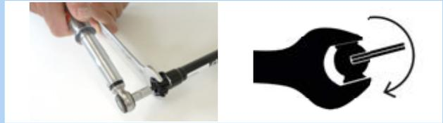
Illustration 167 : Régler dans le sens des aiguilles d'une montre
