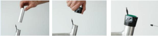
Illustration 202 : Monter la douille de glissement et l'enveloppe extérieure
