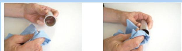
Illustration 160 : Nettoyer le tube de la douille de glissement
