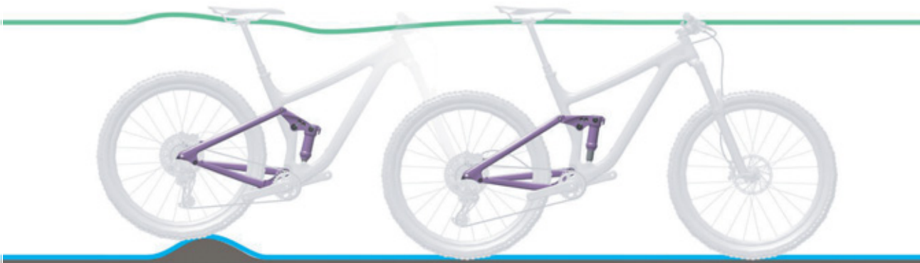
Figura 55: Condición óptima de marcha del amortiguador de la horquilla trasera en caso de irregularidades
