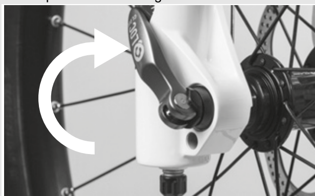
Figura 35: Cierre del cierre rápido
