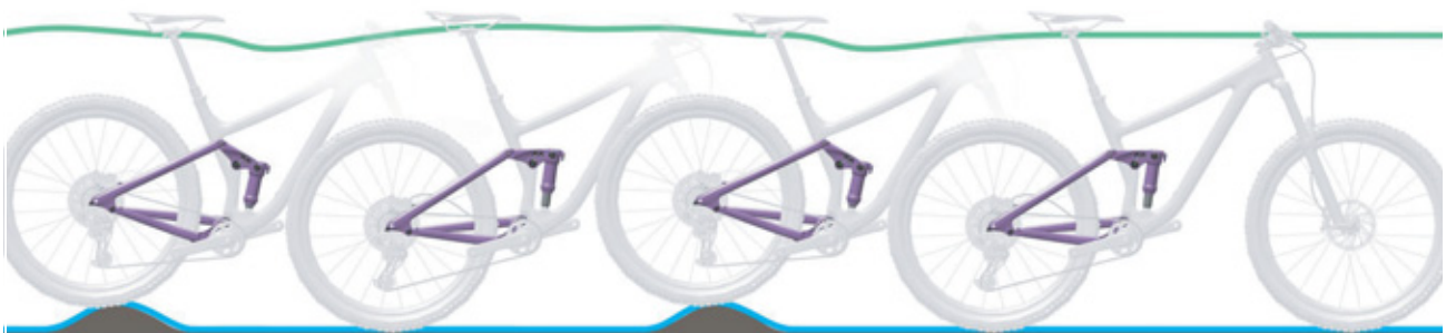
Figura 49: Condición óptima de marcha del amortiguador de la horquilla trasera
