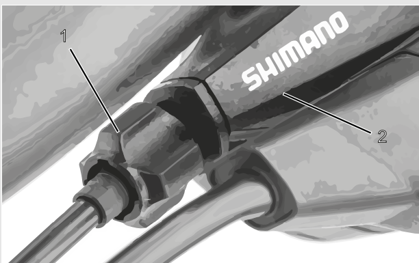
Figura 69: Casquillo de ajuste (1) del cambio de marchas accionado por cable de accionamiento con carcasa de la palanca de cambio (2), ejemplo
