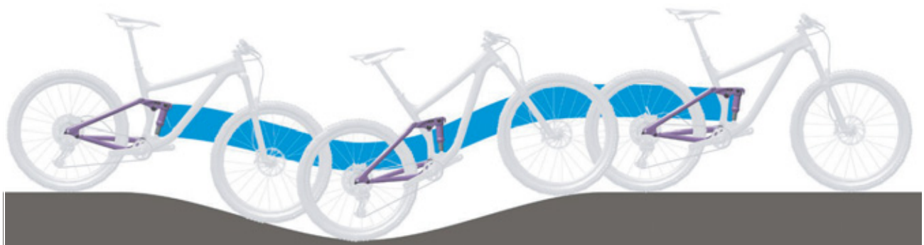
Figura 11: Condición óptima de marcha del amortiguador de la horquilla trasera sobre un terreno accidentado
