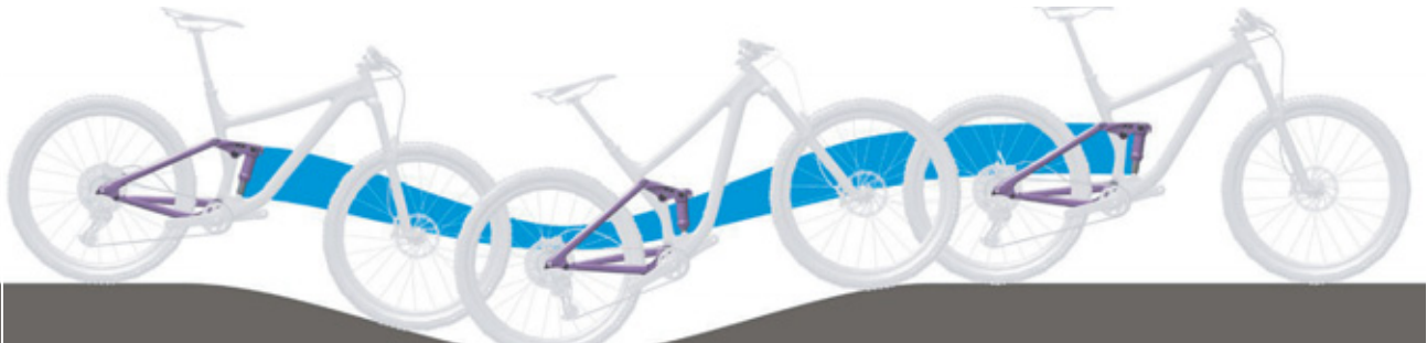
Figura 84: Suspensión del amortiguador de la horquilla trasera demasiado blanda en montaña
