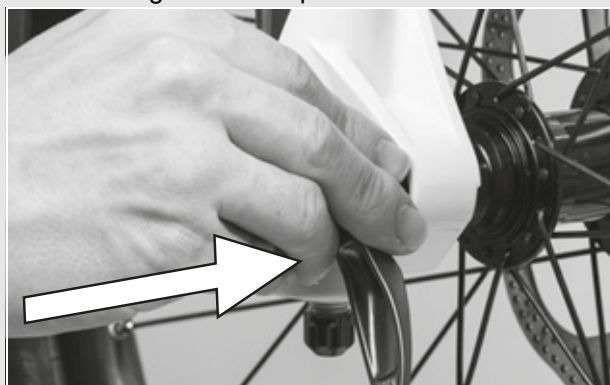
Figura 33: Inserción del cierre rápido
