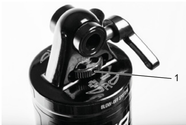
Figura 83: Giro del amortiguador de niveles de tracción en sentido antihorario
