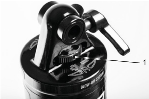
Figura 81: Giro del amortiguador de niveles de tracción en sentido horario
