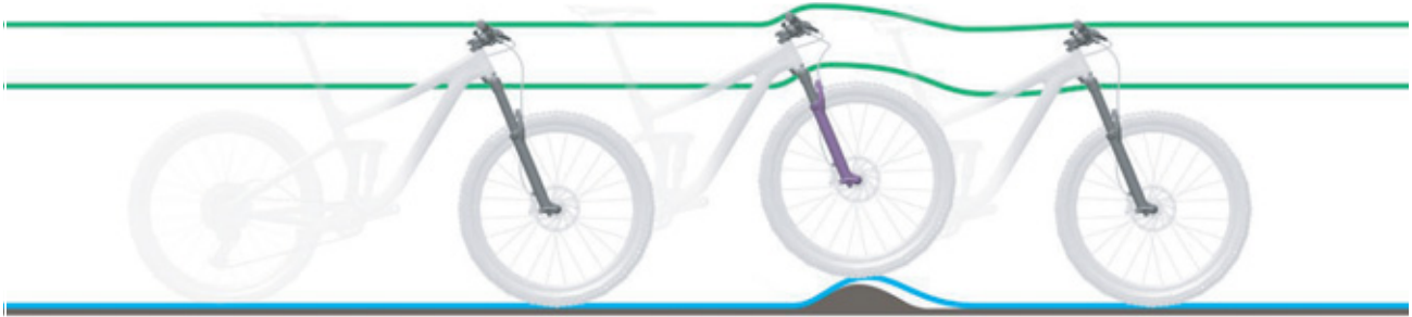
Figura 78: Amortiguación de la horquilla de suspensión demasiado dura en caso de irregularidades
