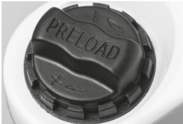
Figura 45: Rueda de ajuste SAG en la corona de la horquilla de suspensión
