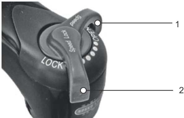
Figura 79: Amortiguador de niveles de presión Suntour en posición abierta (1) y cerrada (2)
