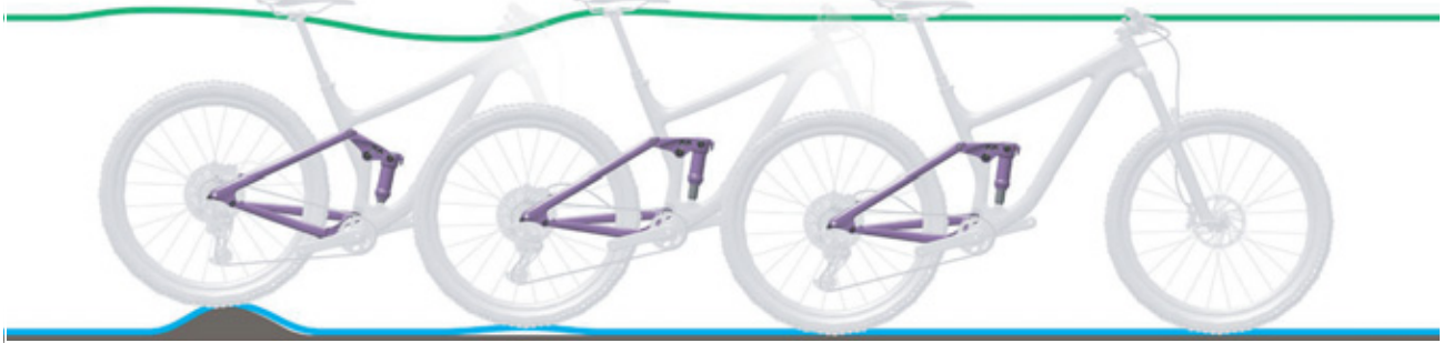
Figura 80: Descompresión demasiado rápida del amortiguador de la horquilla trasera
