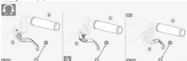
Figura 43: Ajustar el ancho de agarre de la palanca de freno con freno de disco Magura
