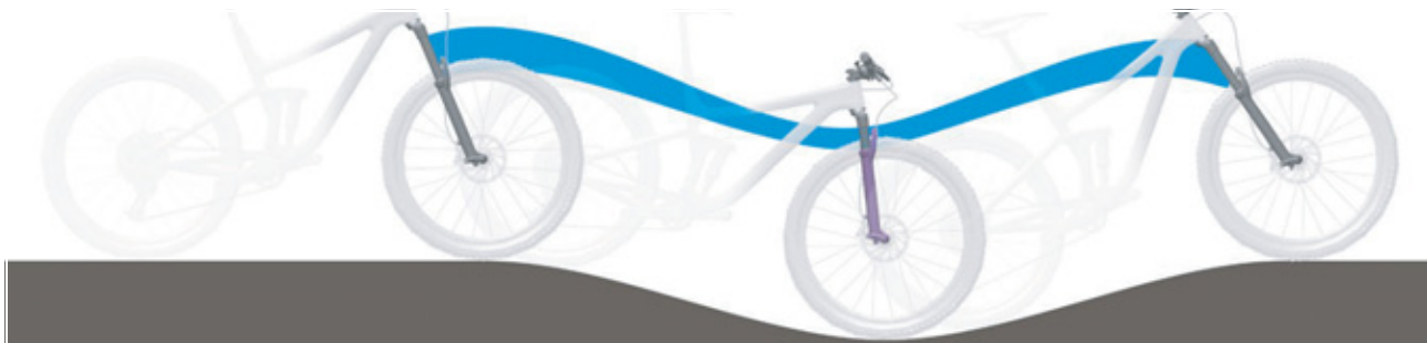
Figura 76: Suspensión de la horquilla de suspensión demasiado blanda en montaña
