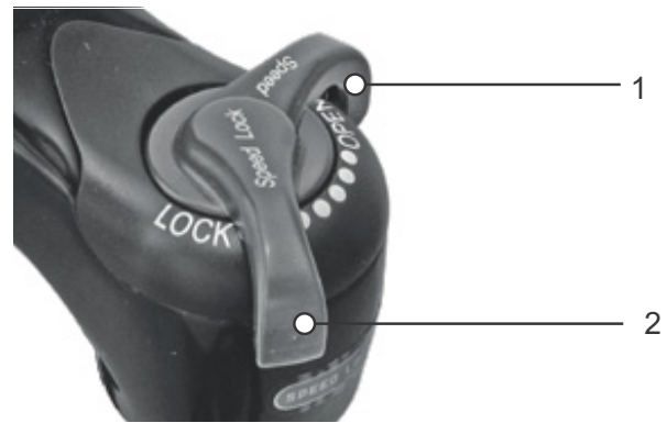
Figura 64: Amortiguador de niveles de presión Suntour en posición abierta (1) y cerrada (2)
