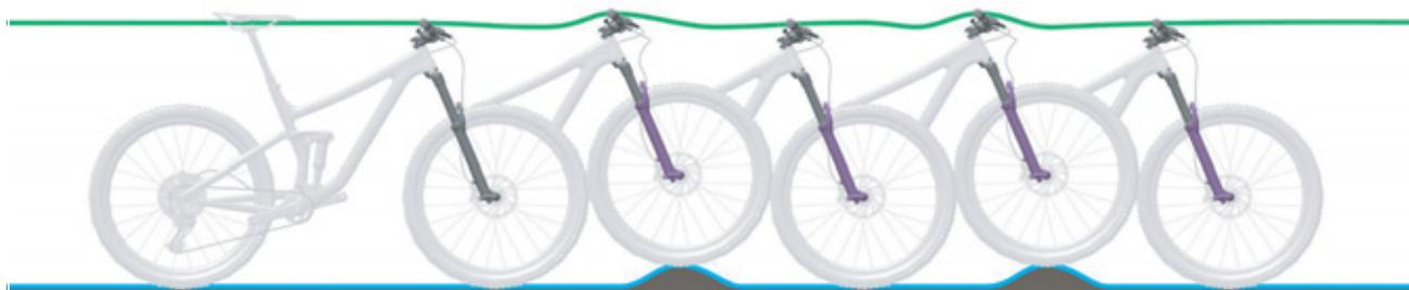
Figura 42: Comportamento di marcia ottimale della forcella
