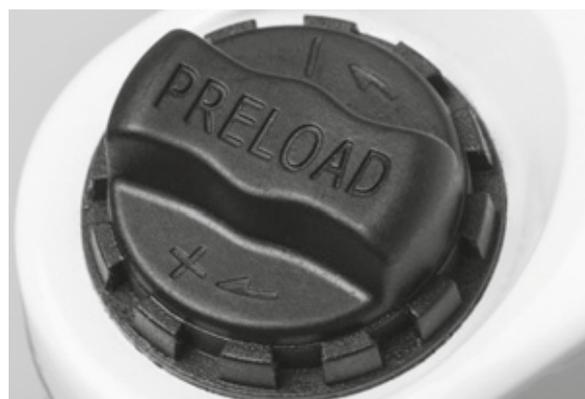
Figura 40: Manopola di regolazione della SAG sulla corona della forcella ammortizzata
