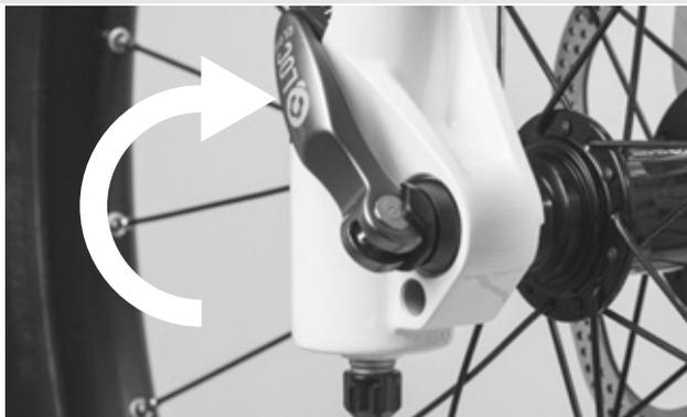
Figura 32: Chiusura del bloccaggio rapido
