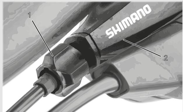
Figura 67: Boccola di regolazione (1) del cambio azionato da cavo singolo con scatola della leva del cambio (2), esempio
