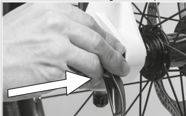
Figura 30: Inserimento del bloccaggio rapido
