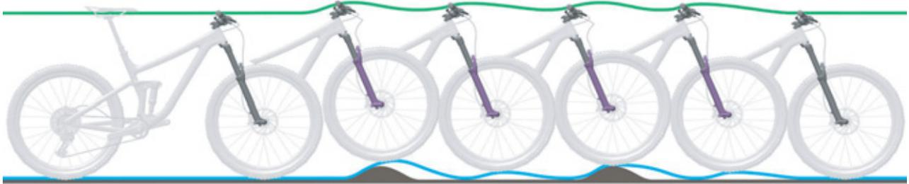
Figura 70: Corsa di estensione troppo veloce della forcella ammortizzata
