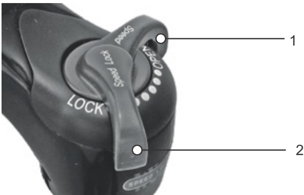
Afbeelding 77: Suntour drukdemper in open (1) en gesloten (2) stand
