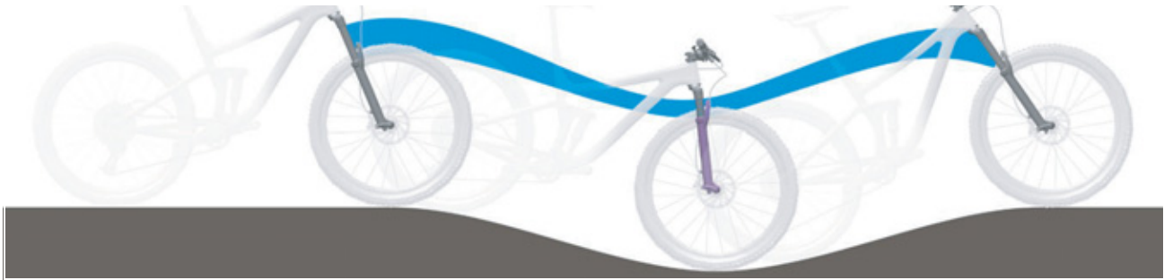
Afbeelding 74: Te zachte vering van de verende voorvork bij kuilen
