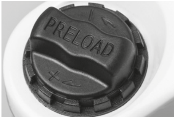
Afbeelding 40: Afstelwiel voor de sag op de kroon van de verende voorvork
