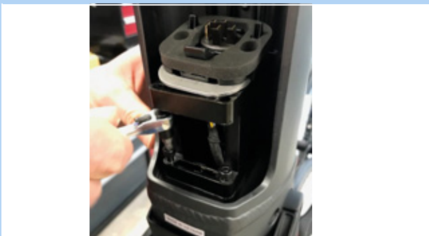
56 paveikslėlis. 4 mm šešiabriaunių varžtų nuėmimas
