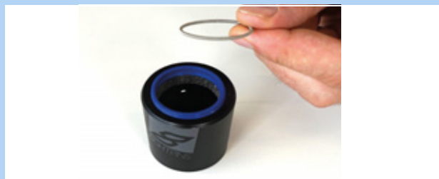
202 paveikslėlis. Nuimta spyruoklinė poveržlė
