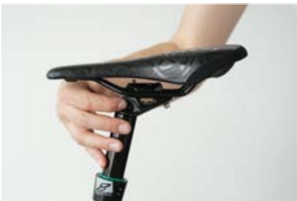
102 paveikslėlis. Balnelio palinkimo kampo nustatymas reguliavimo ratuku
