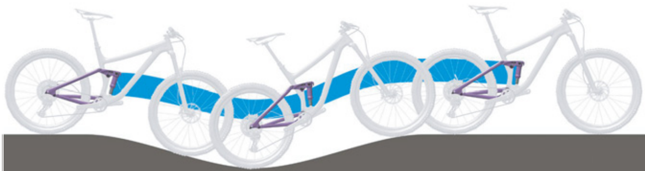
17 paveikslėlis. Optimali galinio amortizatoriaus važiavimo charakteristika kalvotoje vietovėje
