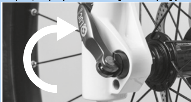
83 paveikslėlis. Ekscentriko uždarymas
