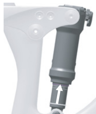
139 paveikslėlis. Žiedinės tarpinės pastūmimas ant galinio amortizatoriaus
