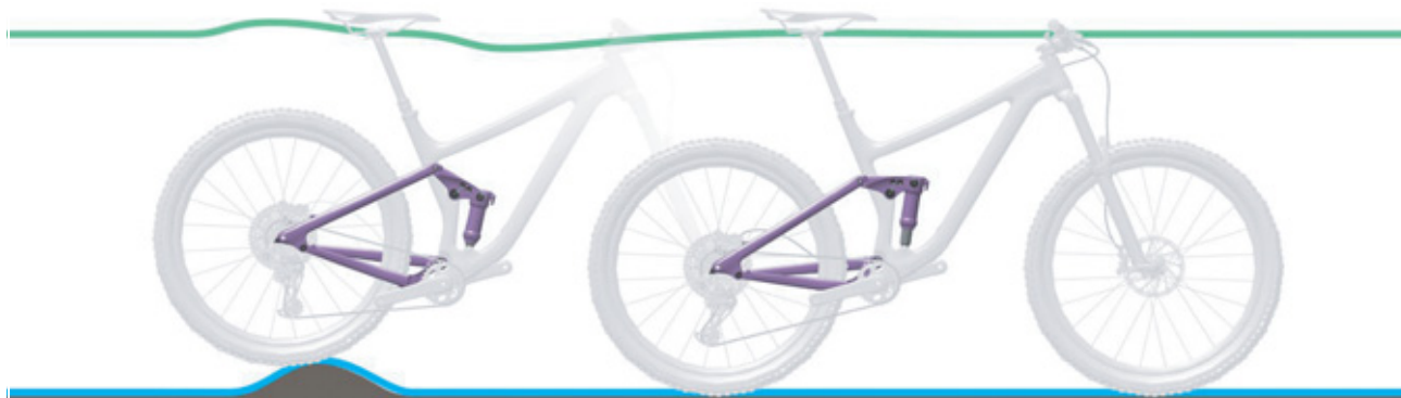
145 paveikslėlis. Optimali galinio amortizatoriaus važiavimo charakteristika nelygumuose
