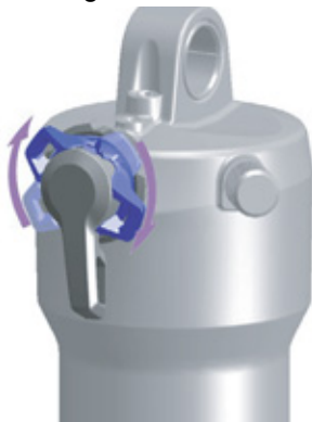
149 paveikslėlis. Kompresijos reguliatorių nustatykite kietesnėje padėtyje
