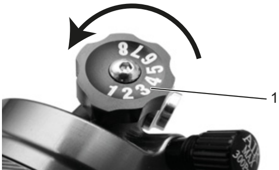
146 paveikslėlis. „Suntour“ kompresinis reguliatorius (1) ant galinio amortizatoriaus
