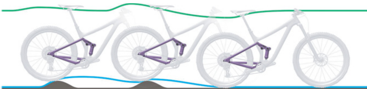
273 paveikslėlis. Per lėtas galinio amortizatoriaus atšokimas
