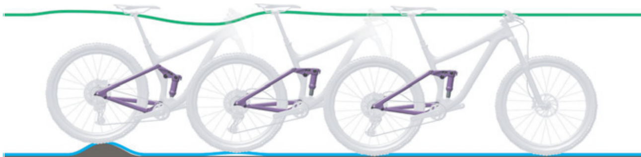
279 paveikslėlis. Per greitas galinio amortizatoriaus atšokimas
