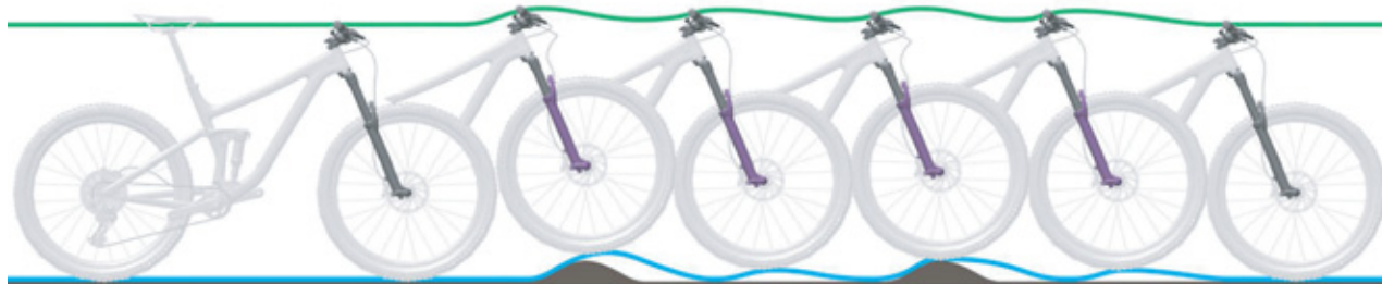
263 paveikslėlis. Per greitas amortizuojančių šakių atšokimas
