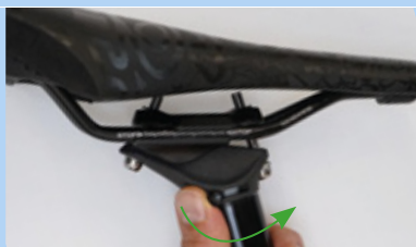
244 paveikslėlis. Atidarykite aukščio reguliatorių
