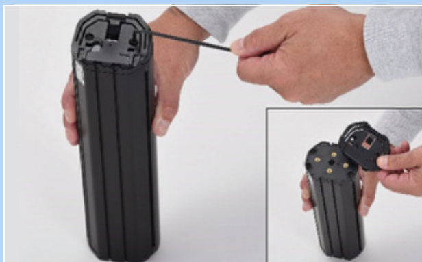
64 paveikslėlis. Viršutinės sąsajos išmontavimas
