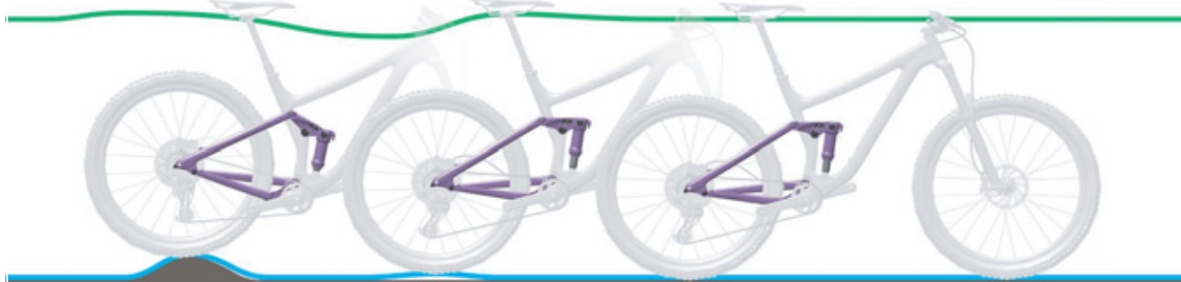
271 paveikslėlis. Per greitas galinio amortizatoriaus atšokimas
