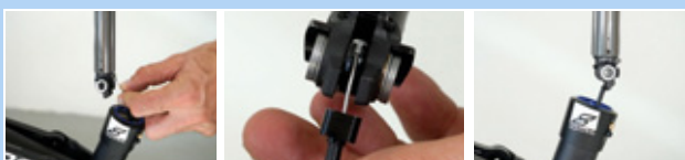
251 paveikslėlis. Įstatykite ir įstumkite balnelio stovą
