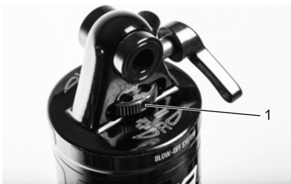
274 paveikslėlis. „Suntour“ atšokimo pakopos reguliatoriaus ratas (1) ant galinio amortizatoriaus
