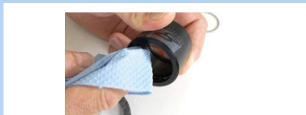
205 paveikslėlis. Išvalykite išorinę movą
