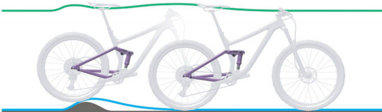
285 paveikslėlis. Per kietas galinio amortizatoriaus amortizavimas nelygumuose
