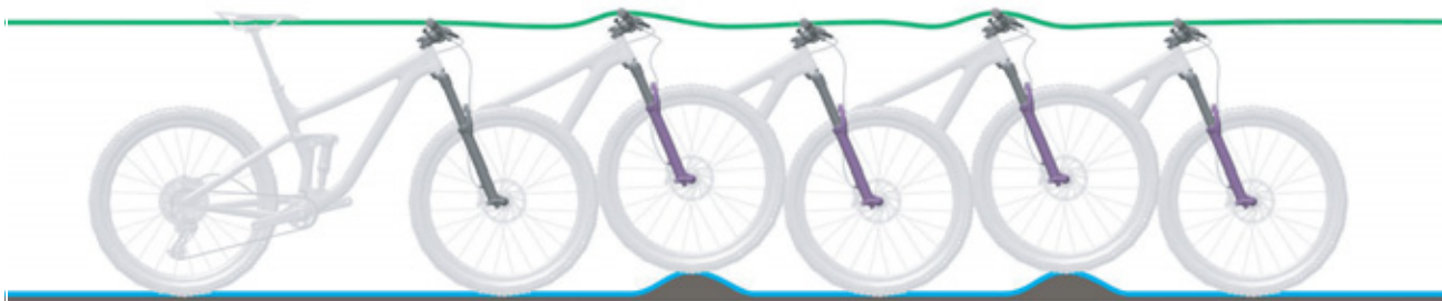
140 paveikslėlis. Optimali šakių važiavimo charakteristika
