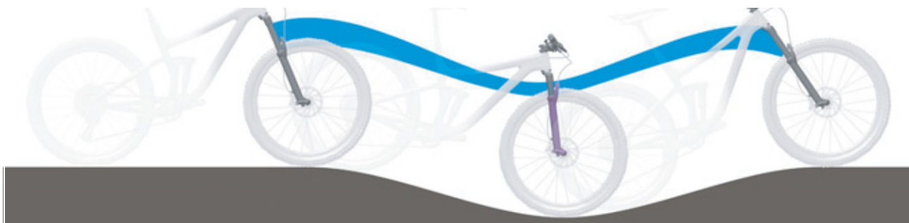
267 paveikslėlis. Ant kalno šakių amortizavimas per minkštas
