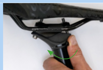
Rysunek 223: Zamykanie mechanizmu regulacji wysokości
