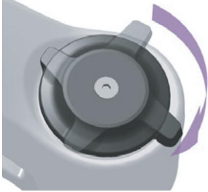
Rysunek 145: Ustawienie nastawnika dobiecia na twardszy tryb pracy
