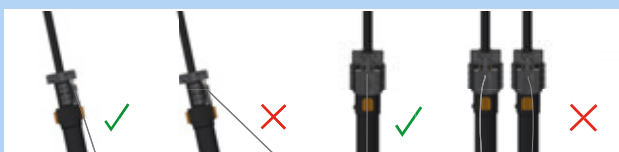
Rysunek 194: Prawidłowa i nieprawidłowa pozycja cięgna Bowdena
