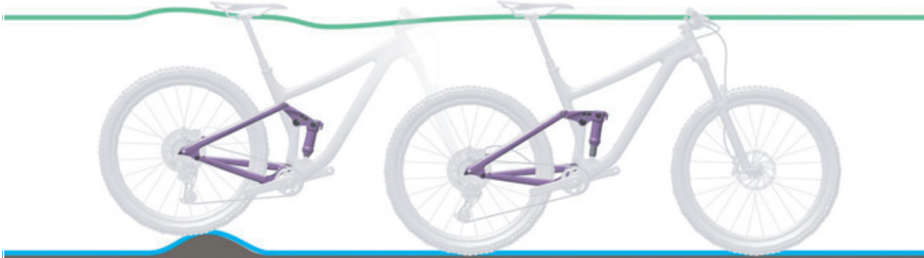
Rysunek 119: Optymalne działanie tylnego amortyzatora na nierównościach
