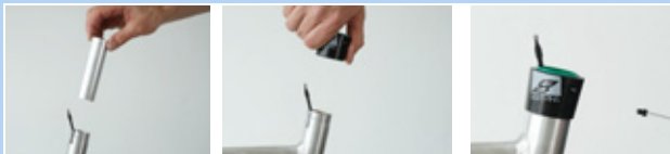
Rysunek 224: Montaż tulei ślizgowej i tulei zewnętrznej
