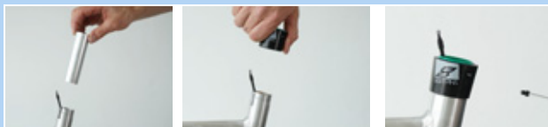
Rysunek 191: Montaż tulei ślizgowej i tulei zewnętrznej
