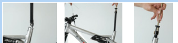
Rysunek 195: Mocowanie nakrętki zaworu wkładu
