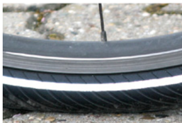
Rysunek 88: Prawidłowe ciśnienie w oponach. Opona prawie nie odkształca się pod wpływem ciężaru ciała.
