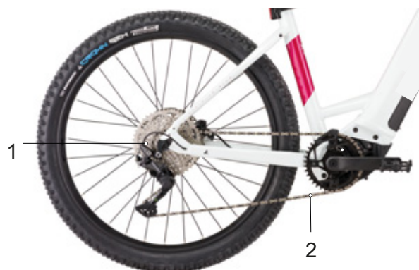
Rysunek 35: Schemat napędu łańcuchowego z przerzutką
