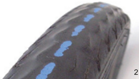
Rysunek 154: Opona bez bieżnika, która jeszcze nadaje się do jazdy (1) i opona z prześwitującą ochroną przed przebicciem (2), którą należy wymienić
