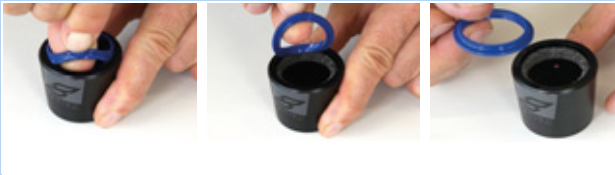
Rysunek 212: Wyciąganie zgarniacza
