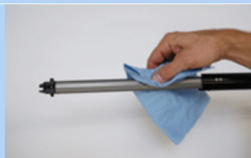
Rysunek 220: Czyszczenie podłużnego rowka prowadzącego
