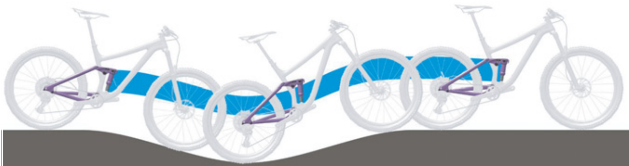
Rysunek 16: Optymalne działanie tylnego amortyzatora na pagórkowatym terenie
