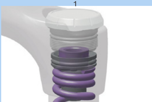
Rysunek 102: Przykręcanie i odkręcanie pierścienia regulacji naprężenia wstępnego
