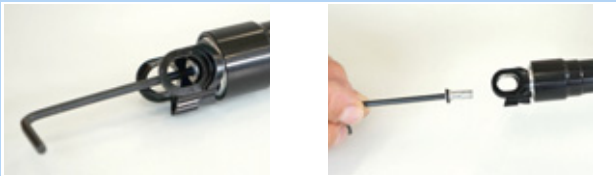
Rysunek 187: Odkręcanie nakrętki zaworu
