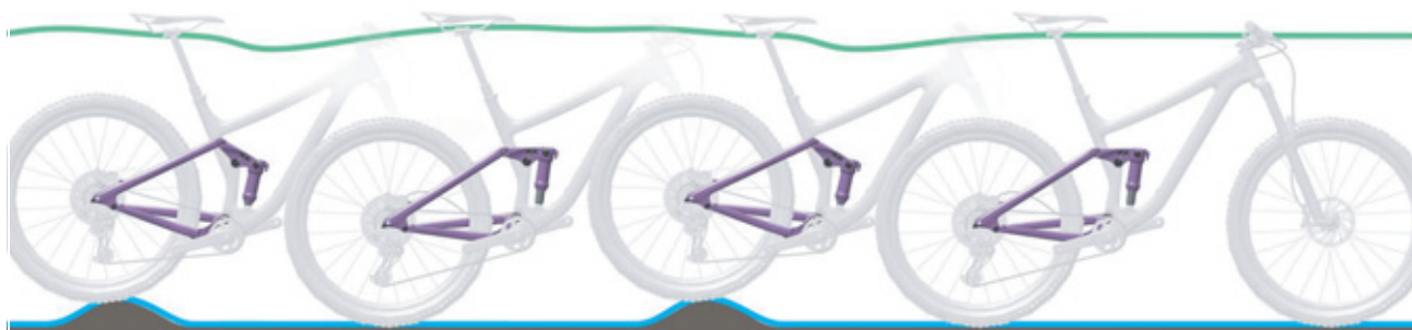
Rysunek 117: Optymalne działanie tylnego amortyzatora
