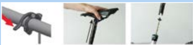
Rysunek 168: Wyciąganie sztycy podsiodłowej
