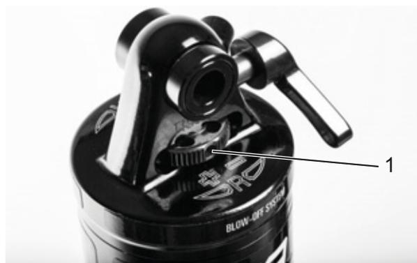
Illustration 51 : Molette de réglage de la détente Suntour (1) sur l'amortisseur arrière
