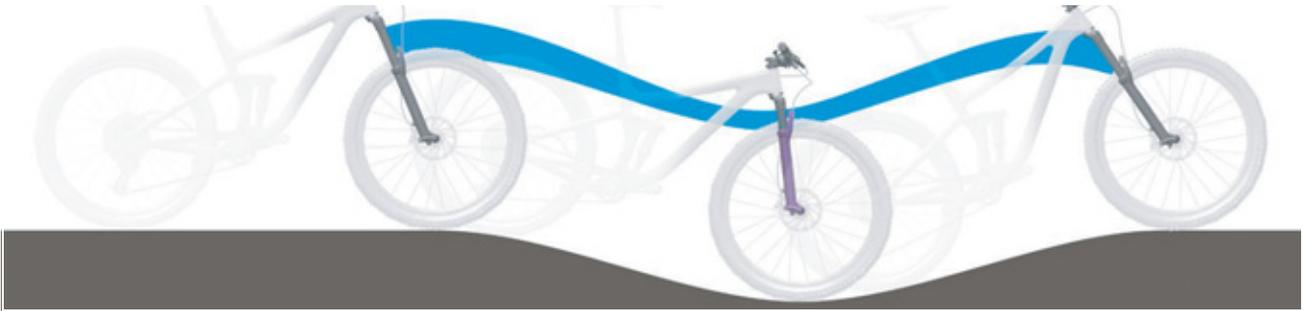
Illustration 76 : Suspension trop souple de la fourche de suspension dans les côtes
