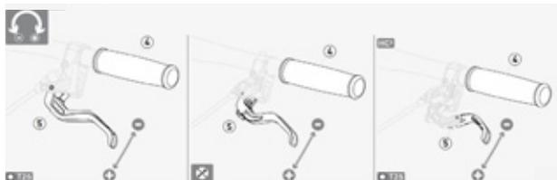
Illustration 43 : Régler la garde d'un levier de frein à disque Magura
