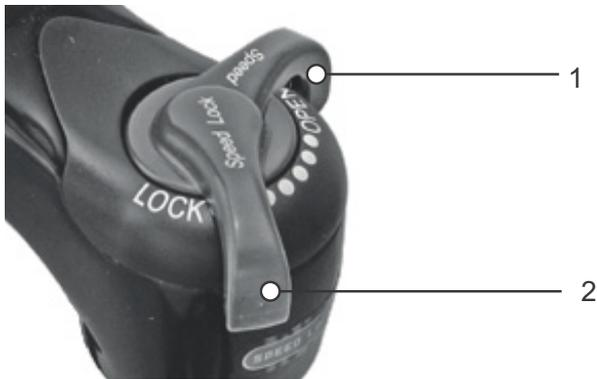
Illustration 79 : Amortisseur de compression Suntour en position ouverte (1) et fermée (2)
