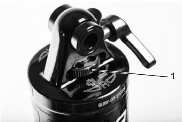
Illustration 83 : Tourner l'amortisseur de détente dans le sens inverse des aiguilles d'une montre
