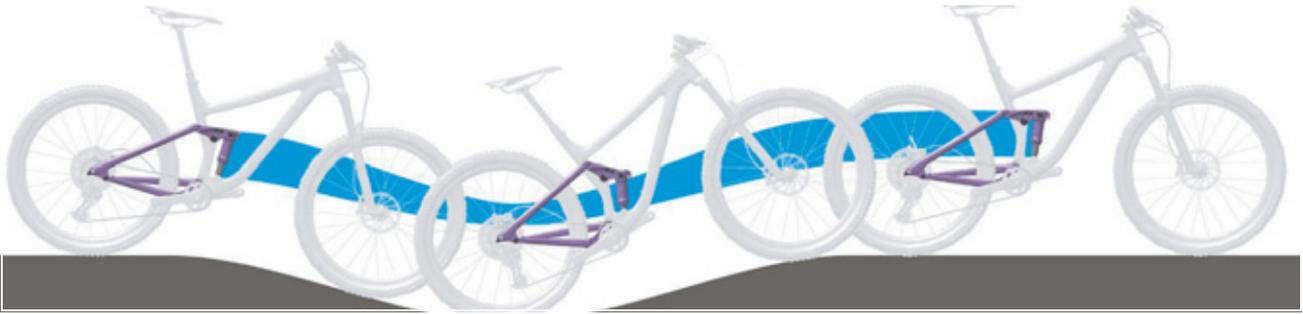
Illustration 84 : Suspension trop souple de l'amortisseur arrière dans les côtes
