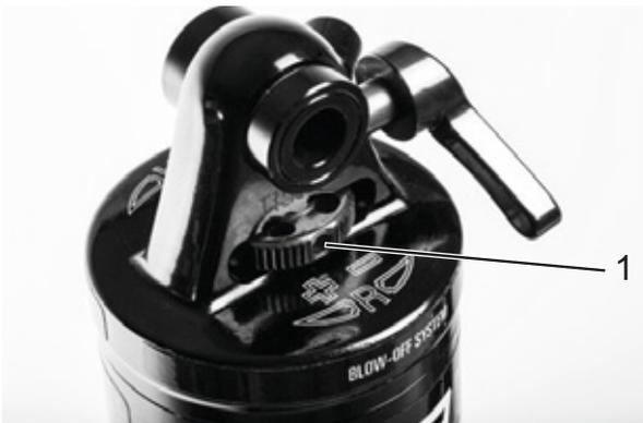
Illustration 81 : Tourner l'amortisseur de détente dans le sens des aiguilles d'une montre
