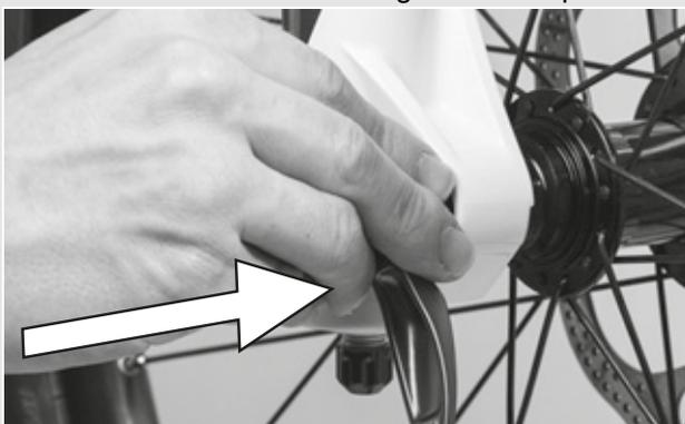
Figura 33: Inserimento del bloccaggio rapido
