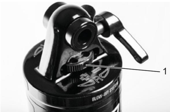
Figura 81: Rotazione dell'ammortizzatore a stadi di trazione in senso orario
