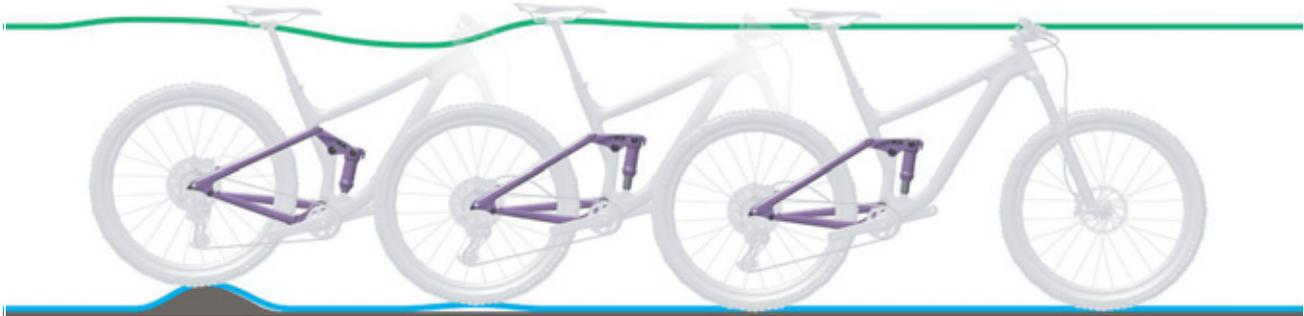
Figura 80: Corsa di estensione troppo veloce dell'ammortizzatore del carro posteriore
