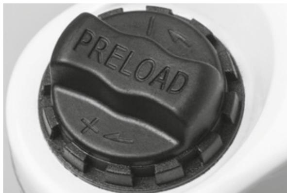
Figura 45: Manopola di regolazione della SAG sulla corona della forcella ammortizzata
