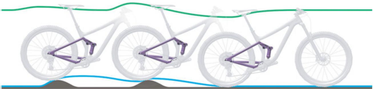
Figura 82: Corsa di estensione troppo lenta dell'ammortizzatore del carro posteriore
