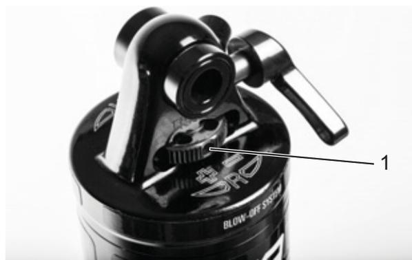
Figura 51: Regolatore del rebound Suntour (1) sull'ammortizzatore del carro posteriore
