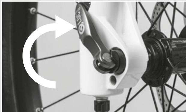
Figura 35: Chiusura del bloccaggio rapido
