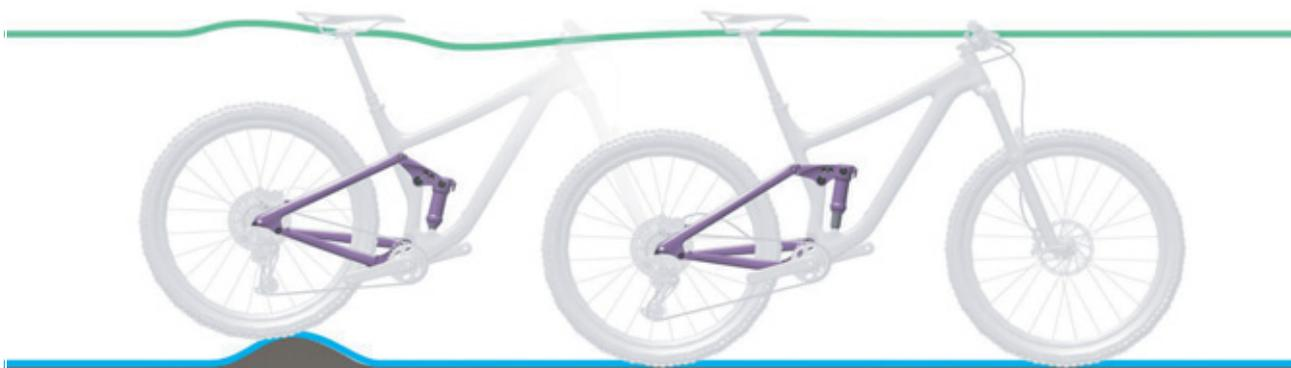
Figura 55: Comportamento di marcia ottimale dell'ammortizzatore del carro posteriore su asperità
