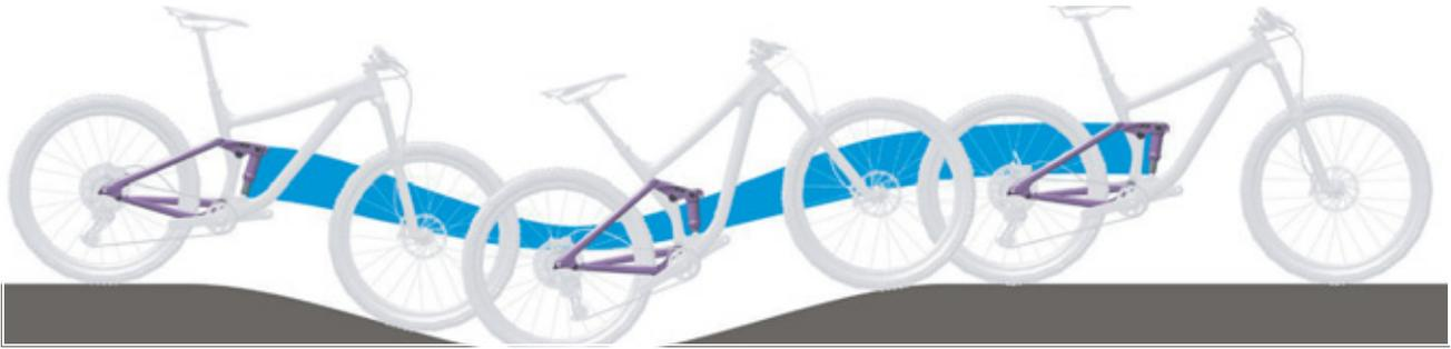
Figura 84: Sospensione dell'ammortizzatore del carro posteriore troppo morbida in salita
