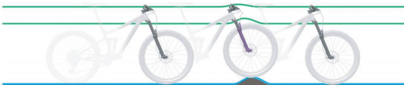
Figura 63: comportamento di marcia ottimale su un terreno con asperità
