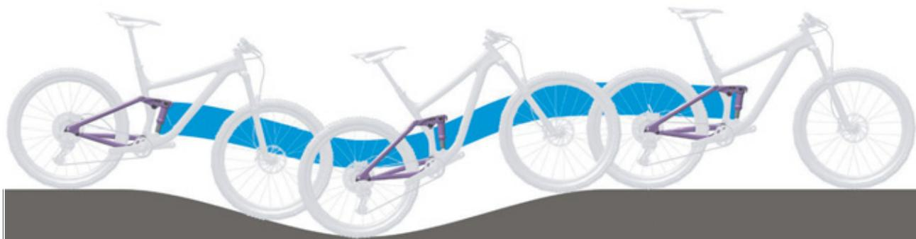
Figura 54: Comportamento di marcia ottimale dell'ammortizzatore del carro posteriore su un terreno con dossi
