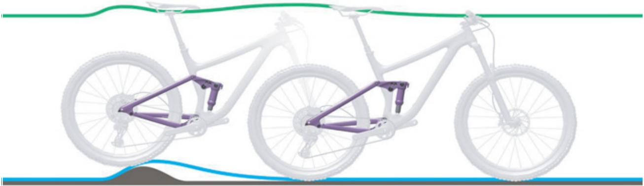
Figura 86: Smorzamento troppo duro dell'ammortizzatore del carro posteriore su asperità
