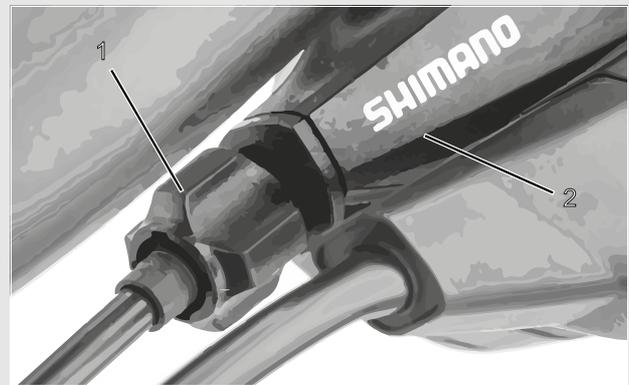
Figura 69: Boccola di regolazione (1) del cambio azionato da cavo singolo con scatola della leva del cambio (2), esempio
