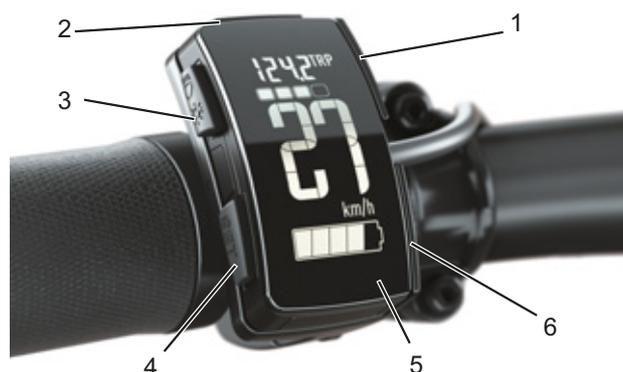
Figura 60: Dettagli del display
