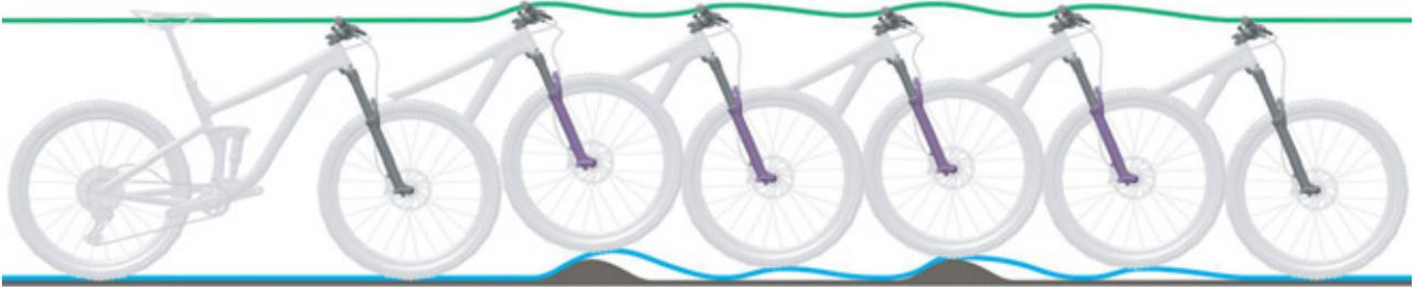
Figura 72: Corsa di estensione troppo veloce della forcella ammortizzata
