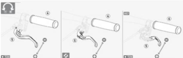
Figura 51: Ajustar el ancho de agarre de la palanca de freno con freno de disco Magura
