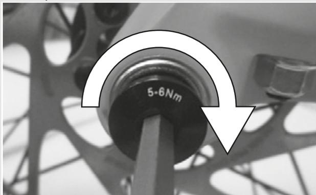
Figura 25: Apriete del tornillo de seguridad
