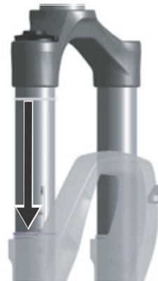
Figura 57: Desplazamiento de la junta tórica en la horquilla de suspensión
