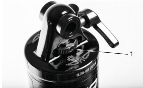
Figura 64: Rueda del regulador de niveles de tracción Suntour (1) en el amortiguador de la horquilla trasera
