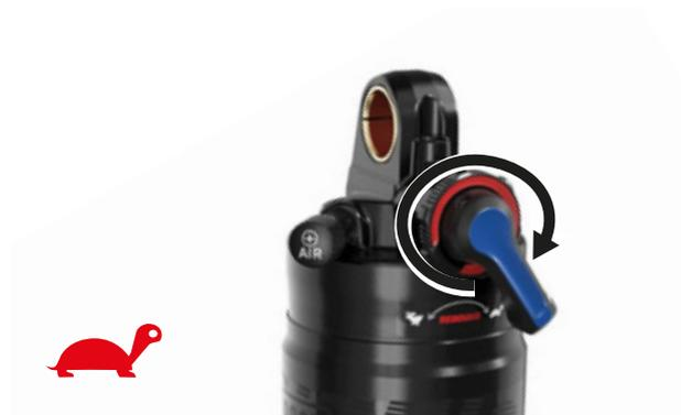
Figura 66: Reducción de la velocidad de descompresión
