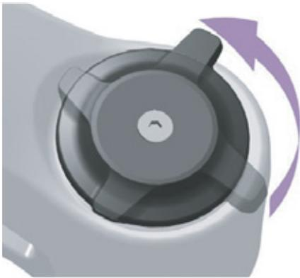
Figura 96: Ajuste para un regulador de niveles de presión más blando
