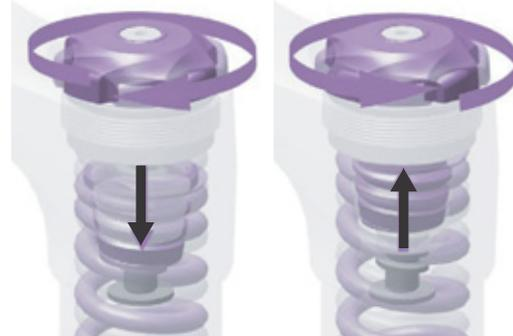
Figura 55: Enroscado y desenroscado del anillo de ajuste de la tensión previa.
