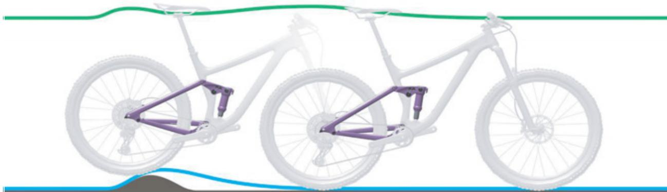
Figura 103: Amortiguación del amortiguador de la horquilla trasera demasiado dura en caso de irregularidades
