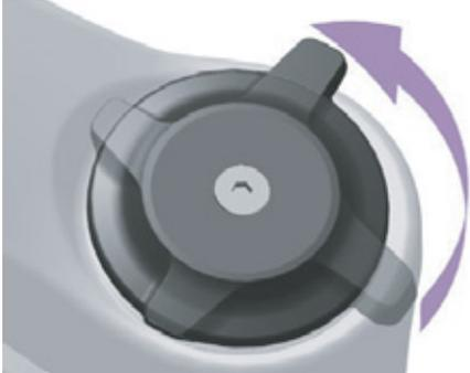
Figura 79: Ajuste para un regulador de niveles de presión más blando
