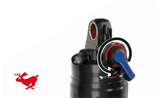
Figura 67: Incremento de la velocidad de descompresión
