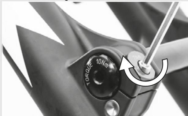
Figura 27: Apriete la abrazadera de sujeción
