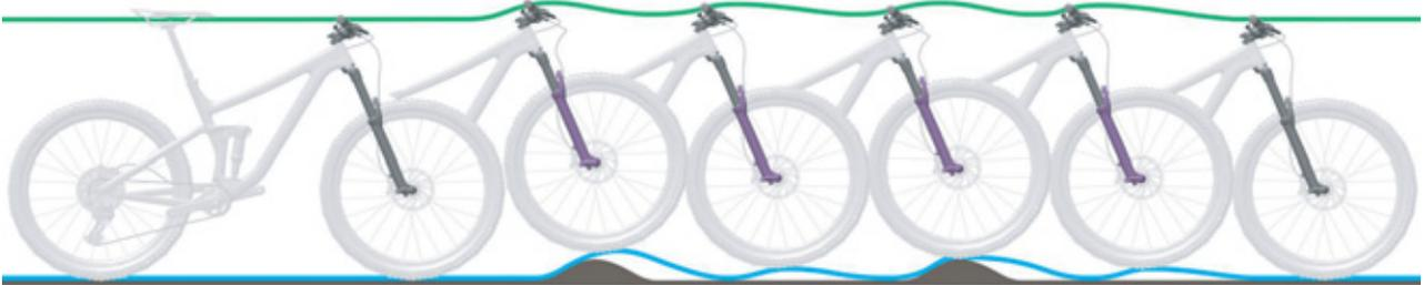
Figura 89: Descompresión demasiado rápida de la horquilla de suspensión
