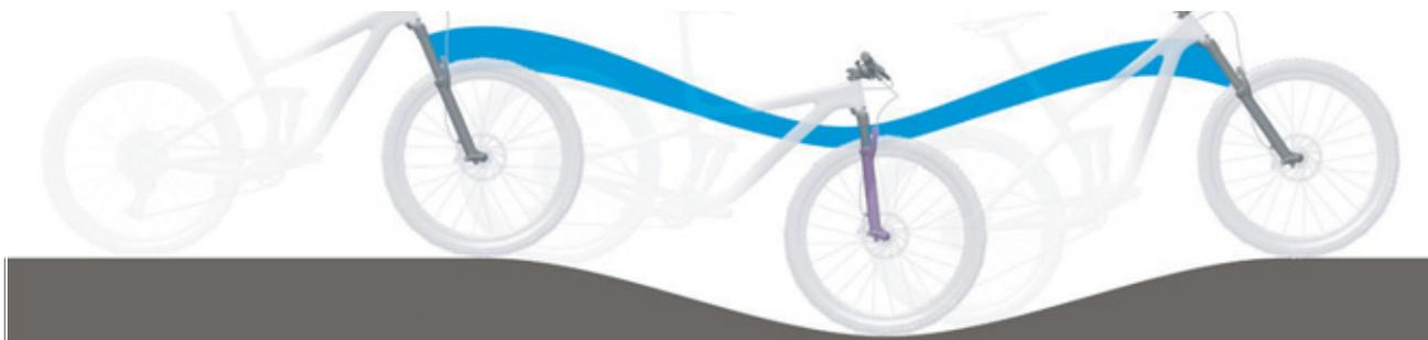
Figura 93: Suspensión de la horquilla de suspensión demasiado blanda en montaña
