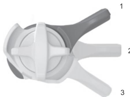
Illustration 65 : Dispositif de réglage de la compression FOX sur l'amortisseur arrière avec les positions OUVERT (1), MOYEN (2) et DUR (3)
