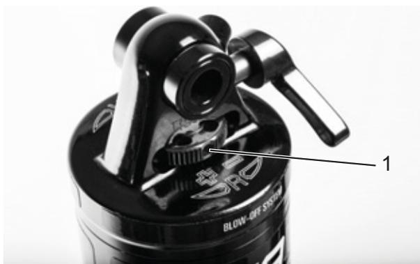
Illustration 56 : Molette de réglage de la détente Suntour (1) sur l'amortisseur arrière
