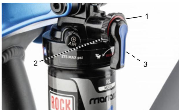
Illustration 70 : Régler la dureté de l'amortisseur de détente (1) de l'amortisseur arrière
