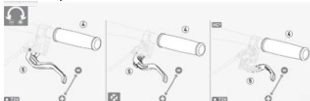
Illustration 50 : Régler la garde d'un levier de frein à disque Magura
