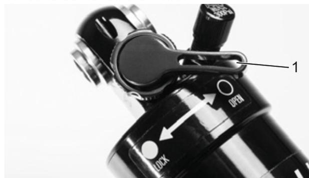
Illustration 68 : Dispositif de réglage de la compression Suntour ouvert (1)
