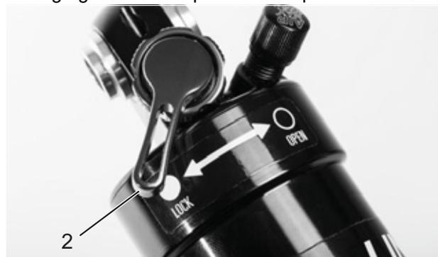
Illustration 69 : Dispositif de réglage de la compression Suntour fermé (2)
