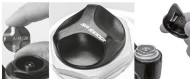
Figura 30: Coperture a vite di diverse versioni
