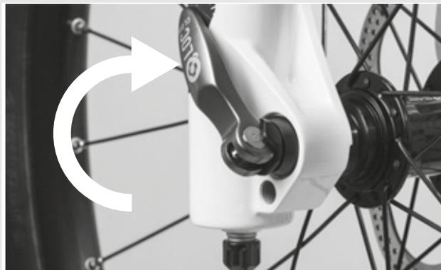
Figura 21: Chiusura del bloccaggio rapido
