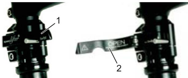
Figura 27: Leva di serraggio dell'attacco manubrio chiusa (1) e aperta (2), esempio by.schulz speedlifter
