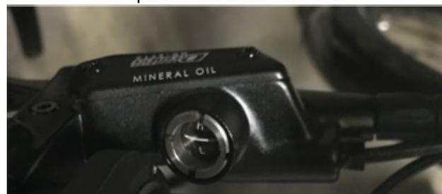
Figura 6: Finestrella di controllo del livello dell'olio
