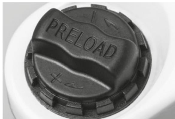
Figura 29: Manopola di regolazione dell'escursione negativa della sospensione sulla corona della forcella ammortizzata
