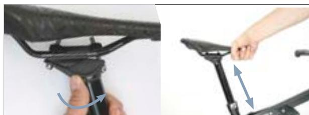
Figura 123: Ajuste de la altura de la tija de sillín
