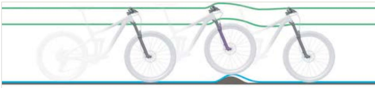
Figura 315: Amortiguación de la horquilla de suspensión demasiado dura en caso de irregularidades
