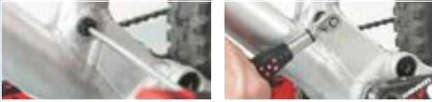
Figura 276: Fijación del eje Postpin
