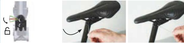
Figura 246: Colocar el accionamiento del ajuste de altura en la "Posición abierta"
