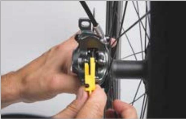
Figura 215: Comprobación de la almohadilla de freno montada con ayuda del seguro de transporte
