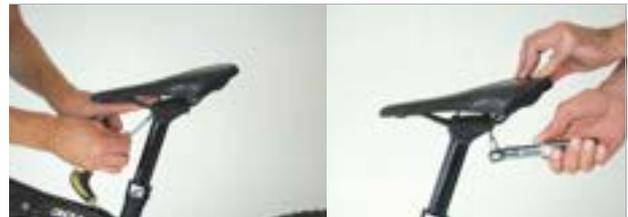
Figura 129: Fijación del tornillo delantero y trasero
