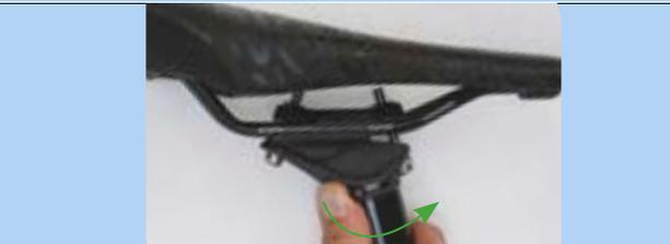
Figura 297: Apertura del ajuste de altura
