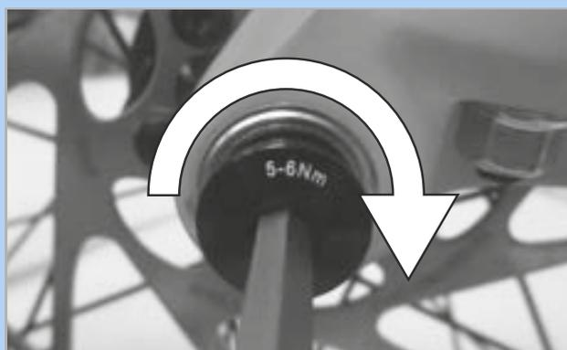
Figura 92: Apriete del tornillo de seguridad
