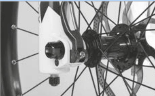
Figura 97: Posición perfecta de la palanca tensora
