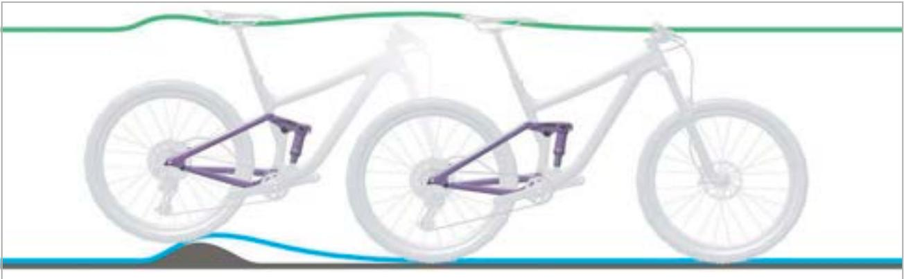
Figura 337: Amortiguación del amortiguador de la horquilla trasera demasiado dura en caso de irregularidades
