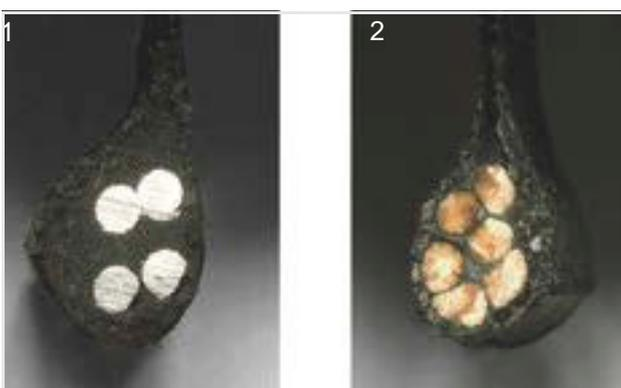
Figura 31: Núcleo de acero (1) y núcleo de Kevlar (2)
