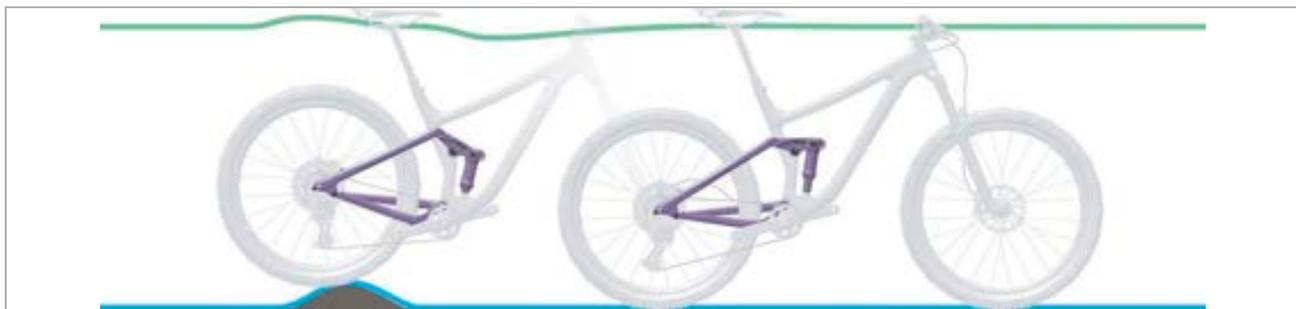
Figura 7: Condición óptima de marcha del amortiguador de la horquilla trasera en caso de irregularidades
