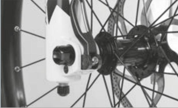
Figura 243: Ajuste de la fuerza de tensado del cierre rápido
