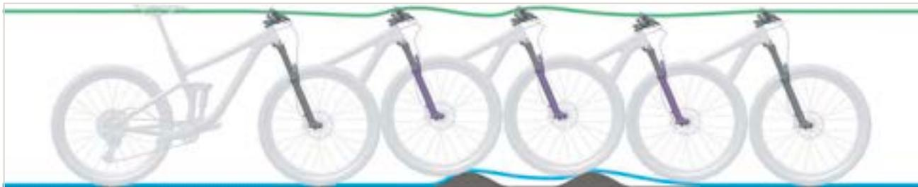
Figura 311: Descompresión demasiado lenta de la horquilla de suspensión
