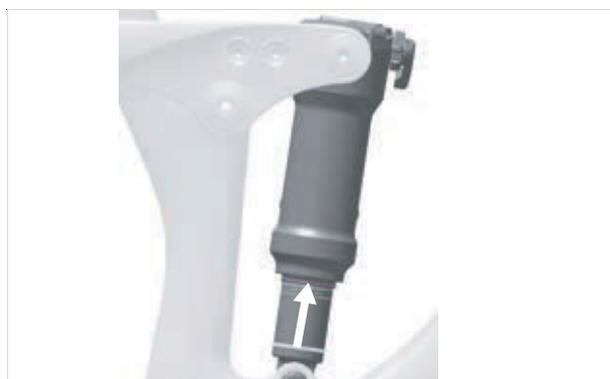
Figura 172: Desplazamiento de la junta tórica en el amortiguador de la horquilla trasera
