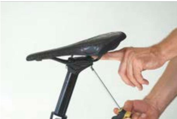
Figura 127: Aflojamiento del tornillo trasero
