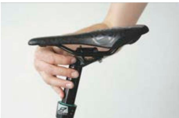
Figura 131: Ajuste de la inclinación del sillín en la rueda de ajuste
