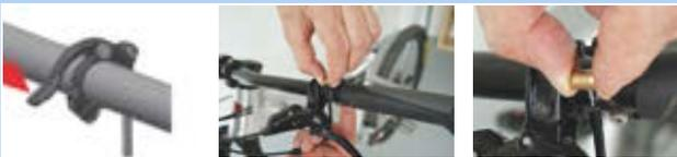
Figura 248: Desmontaje del cartucho
