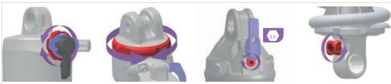
Figura 324: La posición y la forma del regulador de niveles de tracción (amortiguador de la horquilla trasera) (rojo) dependen del modelo
