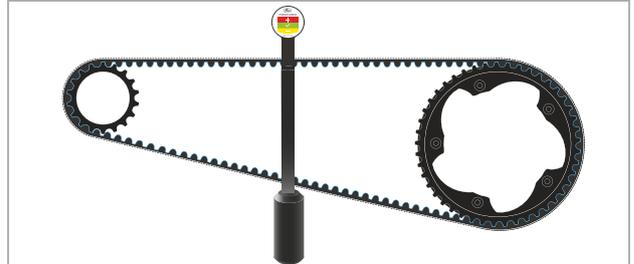
Figura 234: Varilla de medición enganchada
