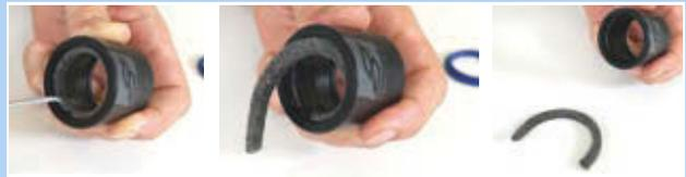
Figura 257: Retirada del anillo de fieltro
