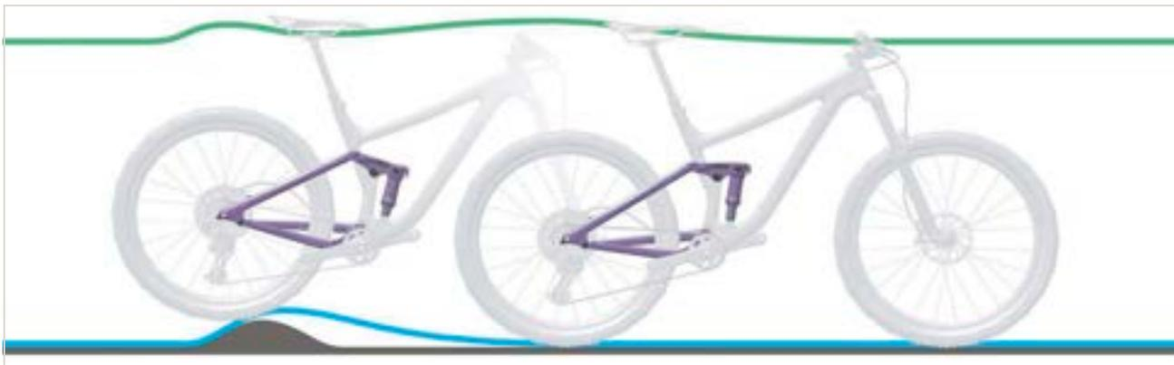
Figura 329: Amortiguación del amortiguador de la horquilla trasera demasiado dura en caso de irregularidades
