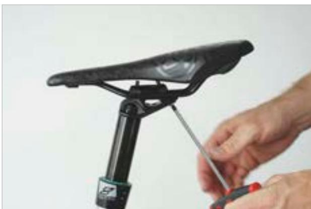
Figura 130: Aflojamiento del tornillo trasero
