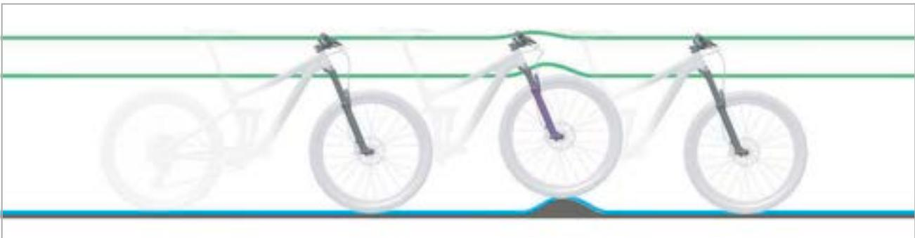
Figura 204: Amortiguador de niveles de presión ajustado en duro y en blando
