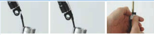
Figura 271: Enganchar la tapa del extremo
