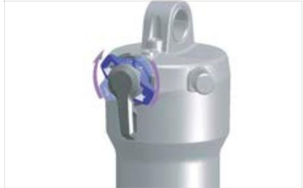
Figura 186: Ajustar el regulador de niveles de presión más duro
