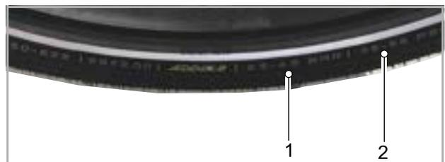
Figura 212: Indicación de presión de inflado en bar (1) y psi (2)
