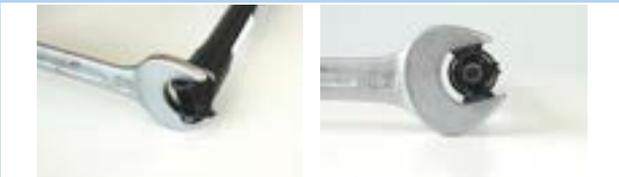
Figura 267: Aseguramiento para evitar el giro
