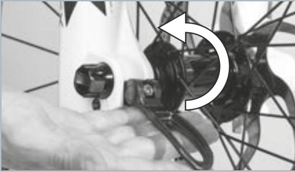
Figura 96: Presión de la palanca de cierre rápido en la dirección de la flecha
