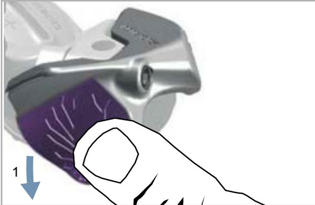
Figura 165: Presionar el interruptor basculante hacia abajo
