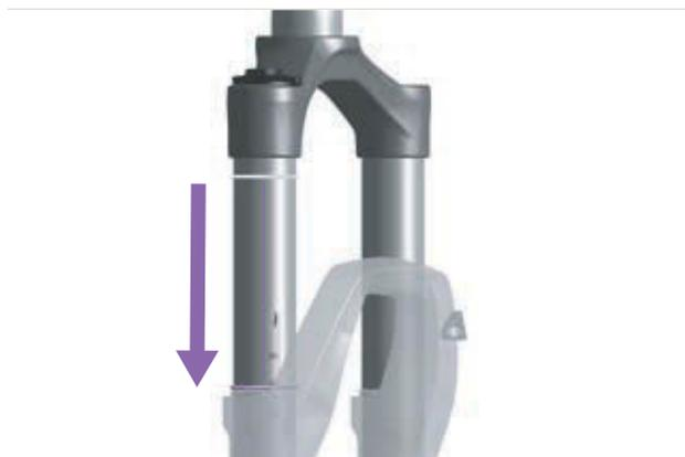
Figura 168: Desplazamiento de la junta tórica de la horquilla de suspensión
