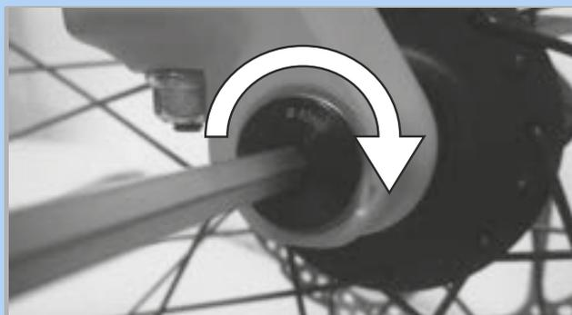
Figura 90: Apriete del eje en la dirección de la flecha
