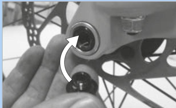
Figura 91: Insertar el tornillo de seguridad
