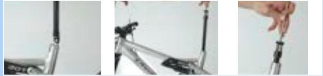
Figura 274: Fijación la tapa de la válvula del cartucho
