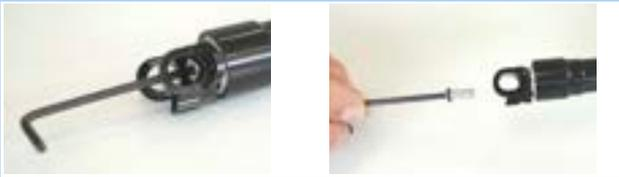
Figura 266: Desenroscar la tapa de la válvula
