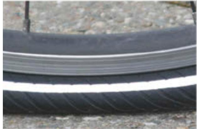
**Figura 144: Presión de inflado demasiado baja**
