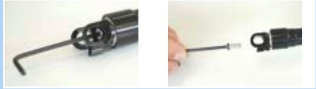
Figura 262: Desenroscar la tapa de la válvula
