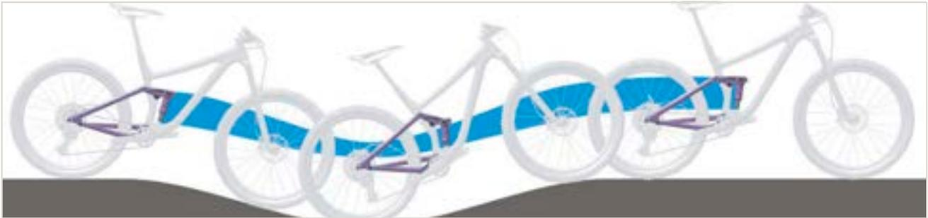
Figura 327: Suspensión del amortiguador de la horquilla trasera demasiado blanda en montaña
