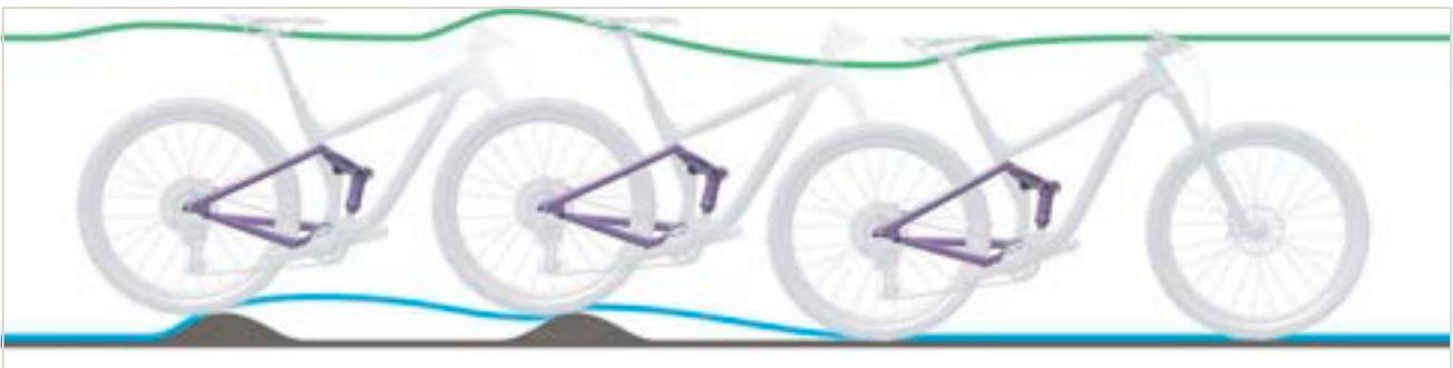
Figura 333: Descompresión demasiado lenta del amortiguador de la horquilla trasera
