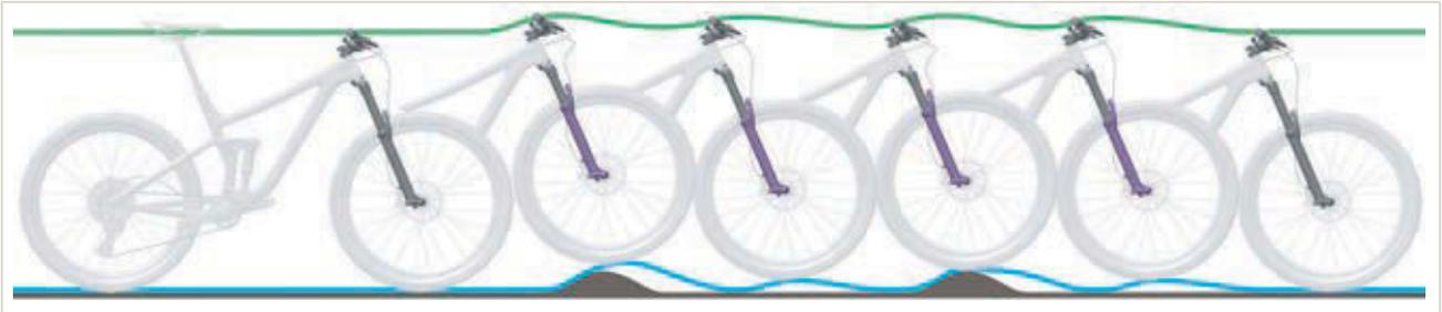
Figura 309: Descompresión demasiado rápida de la horquilla de suspensión
