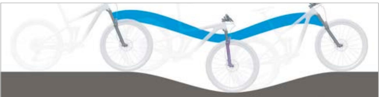
Figura 22: Condición óptima de marcha de la horquilla de suspensión sobre un terreno accidentado
