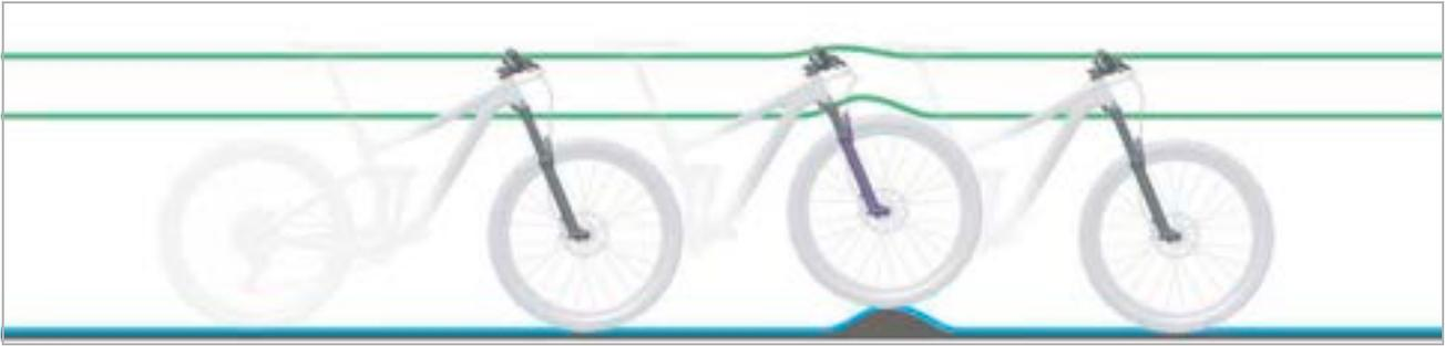
Figura 23: Condición óptima de marcha de la horquilla de suspensión en caso de irregularidades
