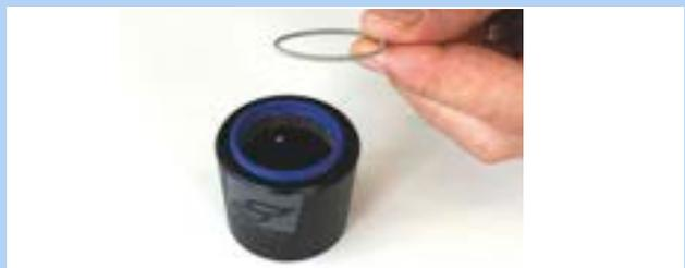
Figura 290: Arandela elástica retirada
