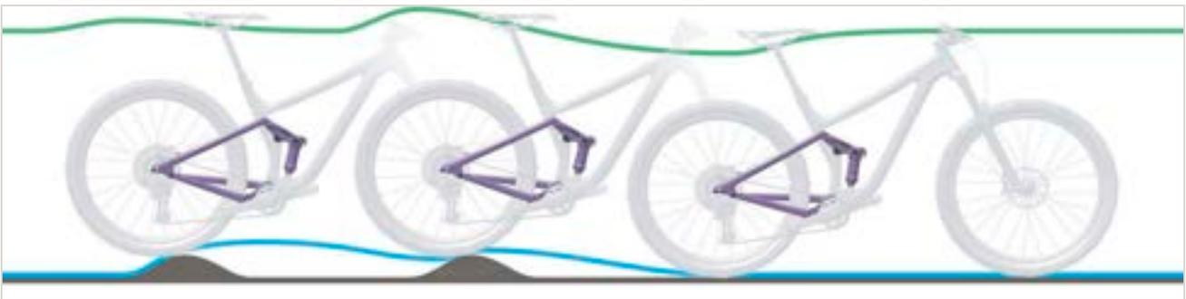
Figura 325: Descompresión demasiado lenta del amortiguador de la horquilla trasera
