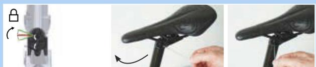
Figura 283: Cierre del ajuste de altura
