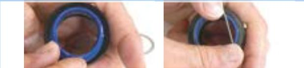
Figura 260: Inserción y fijación del rascador
