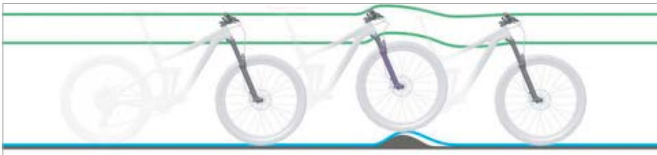
Figura 322: Amortiguación de la horquilla de suspensión demasiado dura en caso de irregularidades
