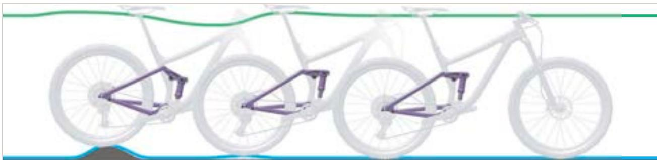
Figura 323: Descompresión demasiado rápida del amortiguador de la horquilla trasera
