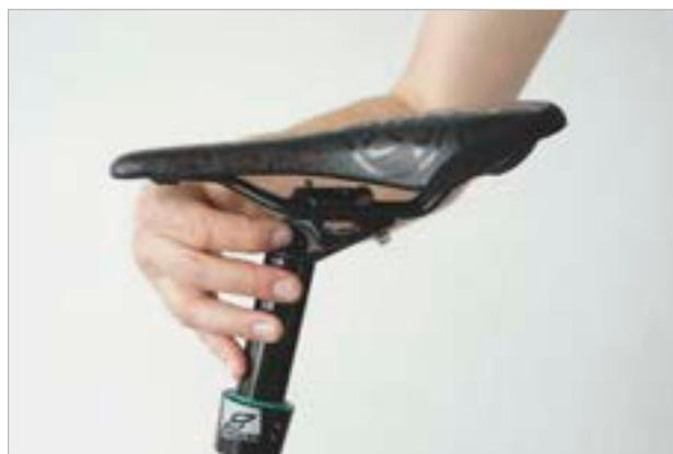
Figura 133: Ajuste de la inclinación del sillín con la rueda de ajuste
