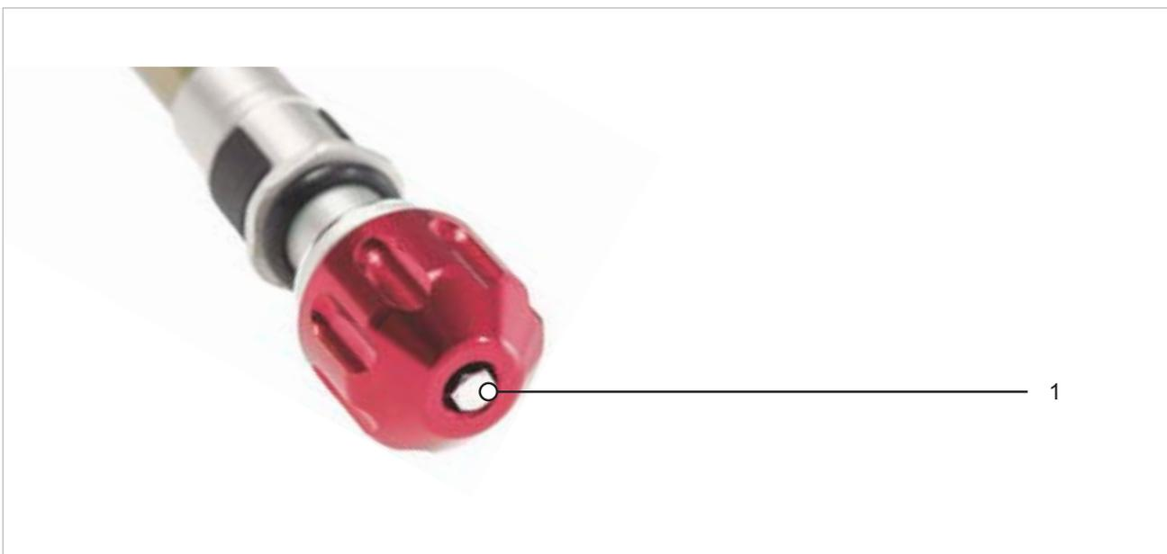
Figura 320: Ejemplo de **regulador de niveles de tracción** (horquilla) SR SUNTOUR (1)
