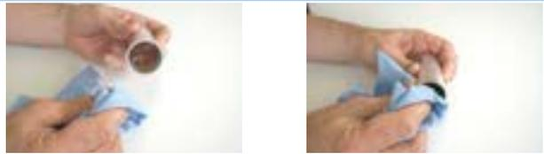
Figura 296: Limpieza del tubo del casquillo deslizante
