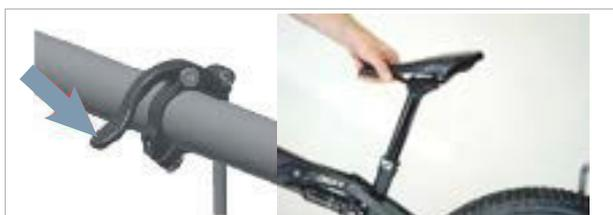
Figura 122: Extracción del muelle de compresión de gas hidráulico
