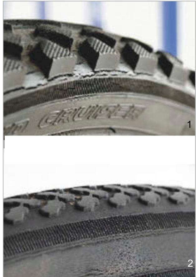
Figura 214: Ejemplos de fisuras por fatiga (1) y fisuras por envejecimiento (2)
