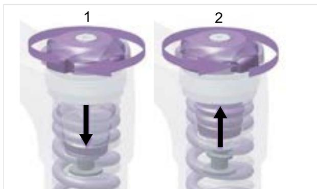
Figura 167: Giro la rueda de ajuste de SAG hacia dentro (1) y hacia fuera (2)
