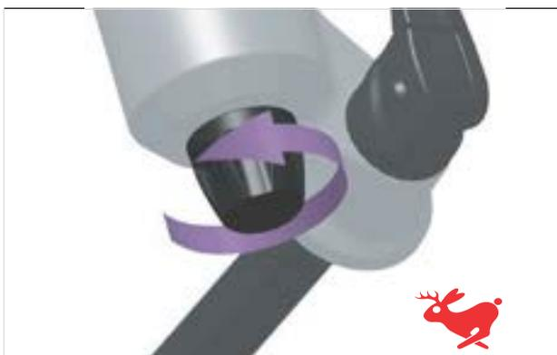
Figura 312: Girar el regulador de niveles de tracción (horquilla de suspensión) en dirección al conejo
