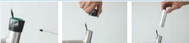
Figura 254: Desmontaje del manguito exterior y del casquillo deslizante
