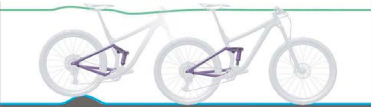
Figura 187: Condición óptima de marcha del amortiguador de la horquilla trasera en caso de irregularidades
