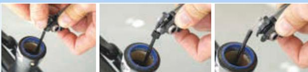
Figura 287: Retirada del cable Bowden
