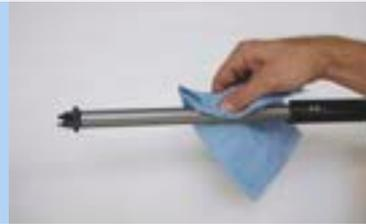
Figura 299: Limpieza de la ranura de guía longitudinal
