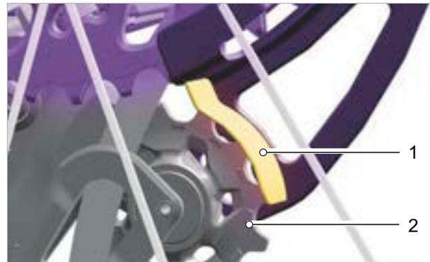
Figura 155: La aleta (1) está en contacto con la polea de inversión superior (2)
