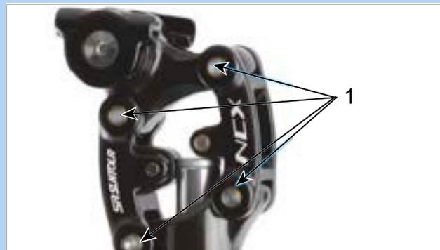
Figura 245: Puntos de lubricación de la tija de sillín de muelle SR SUNTOUR
