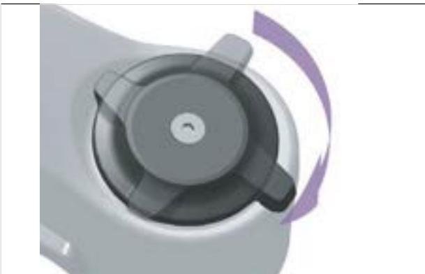
Figura 314: Ajustar el regulador de niveles de presión más duro
