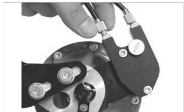
Figura 240: Las versiones de bujes ROHLOFF con activación de cambio externa tienen los dispositivos de ajuste de tensión en la caja de cables que se encuentra en el lado izquierdo
