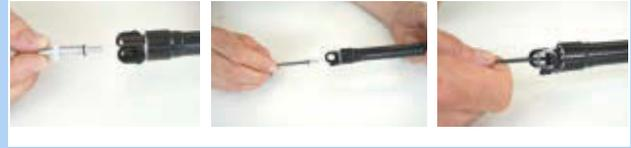
Figura 269: Fijación la tapa de la válvula del cartucho
