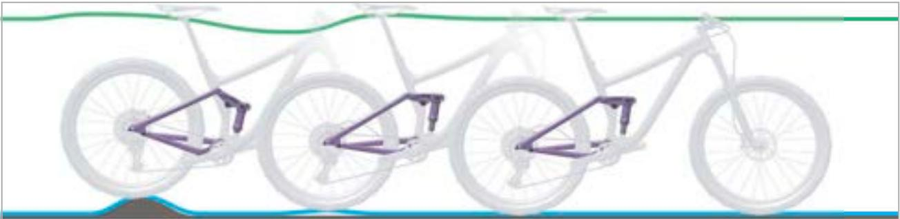
Figura 331: Descompresión demasiado rápida del amortiguador de la horquilla trasera
