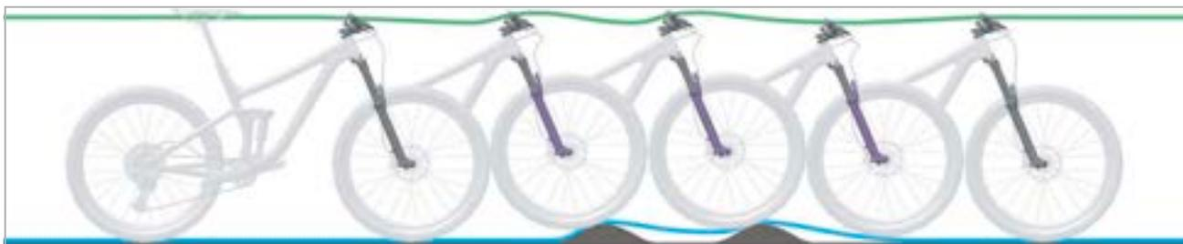
Figura 319: Descompresión demasiado lenta de la horquilla de suspensión
