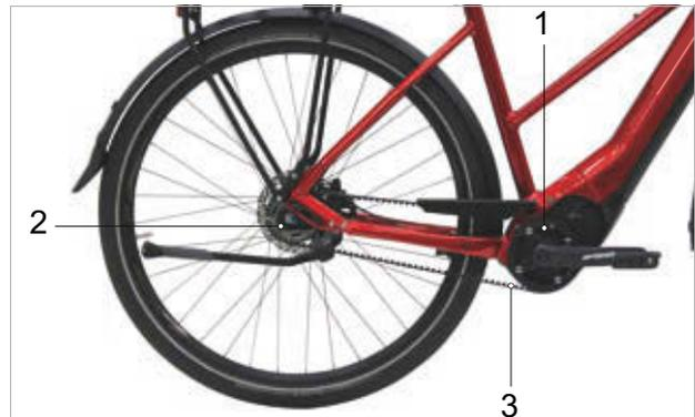
Figura 51: Esquema de la transmisión por correa
