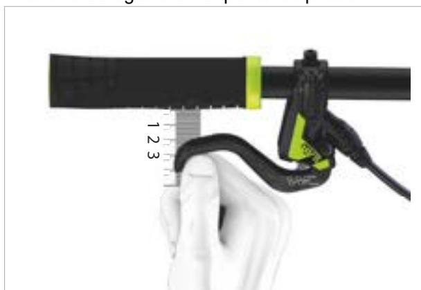
Figura 148: Posicionamiento del freno de mano
