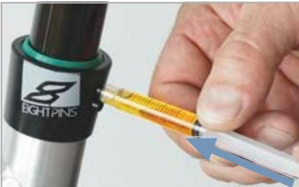
Figura 211: Lubricación de la tija de sillín EIGHTPINS
