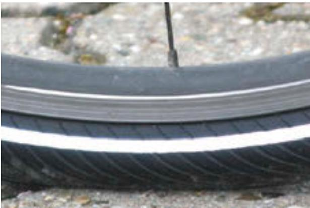
**Figura 143: Presión de inflado correcta. La cubierta apenas está deformada bajo la carga del peso corporal**
