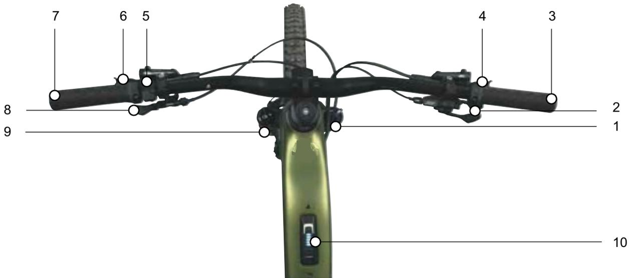
Figura 60: Vista detallada del manillar con ordenador de a bordo de la BOSCH System Controller y unidad de mando Mini Remote, ejemplo
