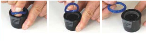
Figura 291: Extracción del rascador
