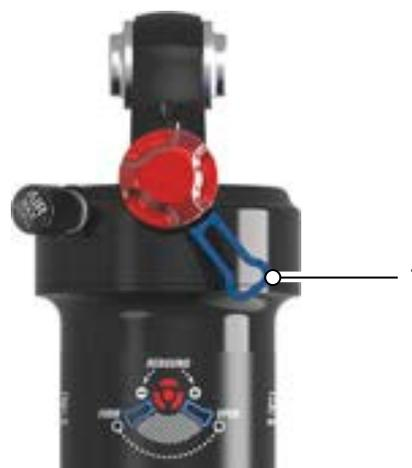
Tabla 56: Palanca de baja velocidad (amortiguador de la horquilla trasera) (1) en el amortiguador de la horquilla trasera EDGE LOR8
