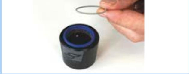
Figura 255: Arandela elástica retirada
