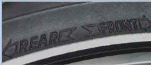
Figura 87: Flecha de sentido de la marcha en cubiertas de MTB
