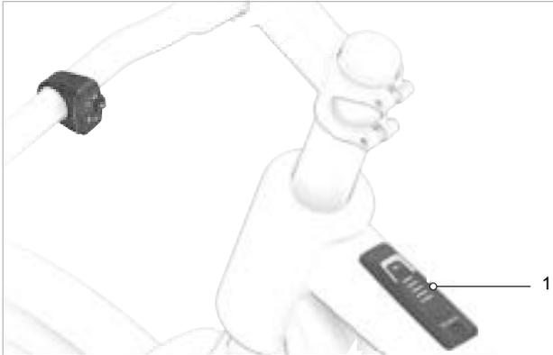
Figura 58: Posición del ordenador de a bordo de la BOSCH System Controller (1)
