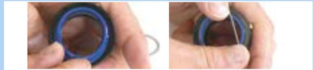
Figura 295: Inserción y fijación del rascador
