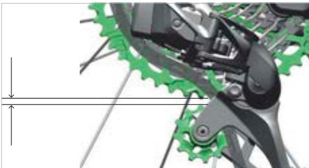
Figura 159: Distancia de 3 mm entre la polea de inversión y los dientes
