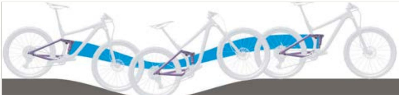
Figura 335: Suspensión del amortiguador de la horquilla trasera demasiado blanda en montaña
