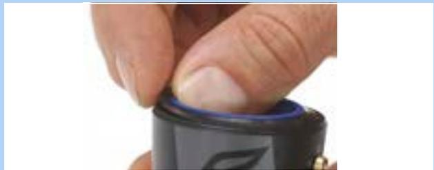
Figura 289: Retirada del anillo con falda de obturación
