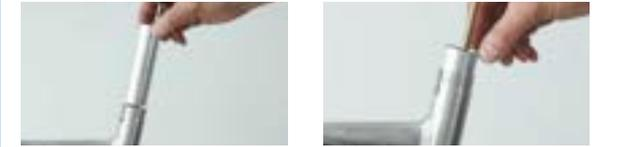
Figura 277: Inserción del tubo del casquillo deslizante en el tubo del sillín
