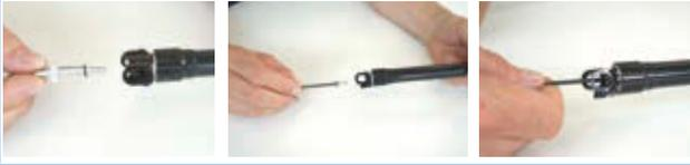
Figura 265: Fijación la tapa de la válvula del cartucho
