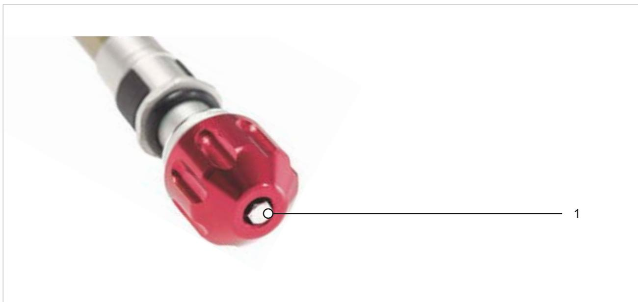
Illustration 318 : Exemple d'un réglage de détente SR SUNTOUR (fourche) (1)
