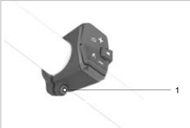
Illustration 340 : Position de la vis de fixation
