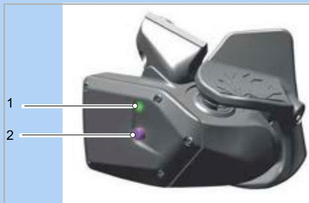
Illustration 107 : Dérailleur arrière SRAM AXS Controller avec affichage LED (dérailleur arrière) (1) et touche AXS (dérailleur arrière) (2)
