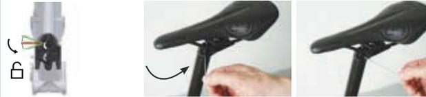
Illustration 246 : Placer le mécanisme de réglage de la hauteur en « position ouverte »
