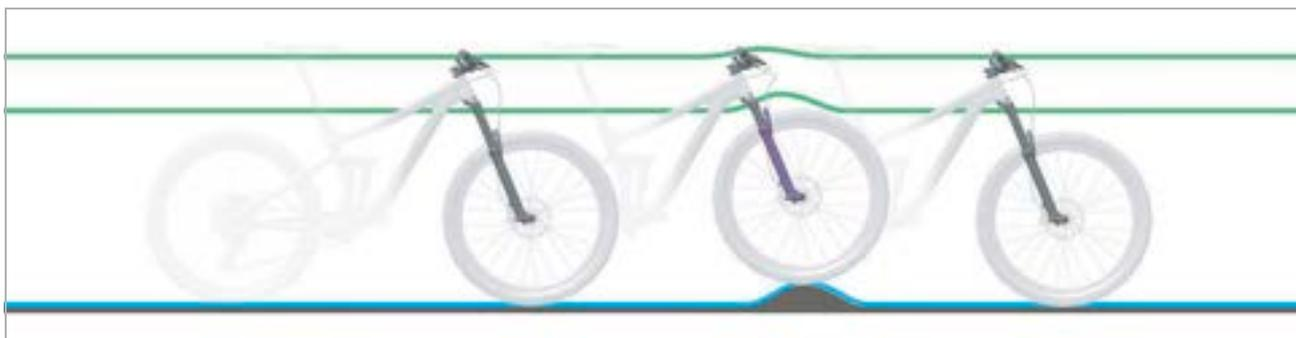
Illustration 204 : Amortisseur de compression avec réglage dur et souple
