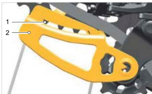
Illustration 154 : Fenêtre découpée (1) avec dents dans le gabarit de mesure Chain Gap (2)
