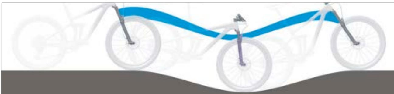
Illustration 321 : Suspension trop souple de la fourche suspendue dans les côtes
