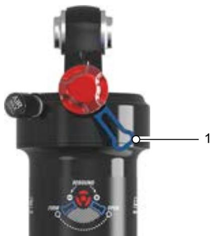
Tableau 56 : Levier Low-Speed (amortisseur arrière) (1) sur amortisseur arrière EDGE LOR8
