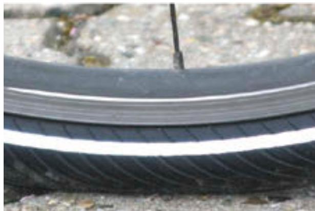
**Illustration 143 : Pression correcte. Le pneu se déforme à peine sous le poids du corps.**
