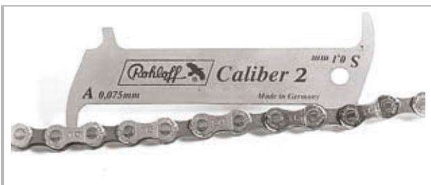
Illustration 220 : Exemple d'un gabarit de mesure ROHLOFF
