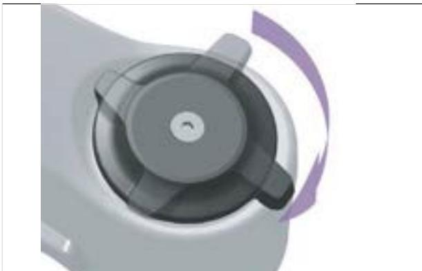
Illustration 314 : Régler le dispositif de réglage de la compression sur un niveau plus dur
