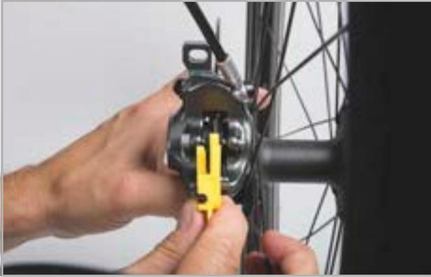
Illustration 215 : Contrôler la plaquette de frein montée à l'aide de la cale de transport
