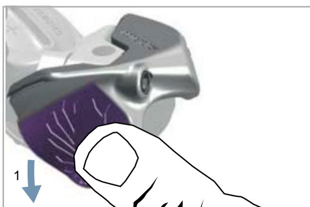
Illustration 160 : Poussez l'interrupteur à bascule vers le bas.
