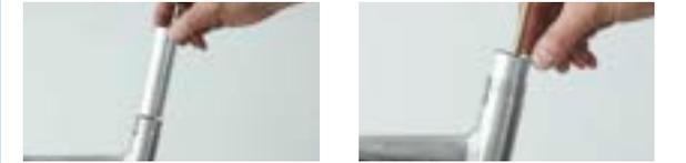
Illustration 277 : Insérer le tube de la douille de glissement dans le tube de selle
