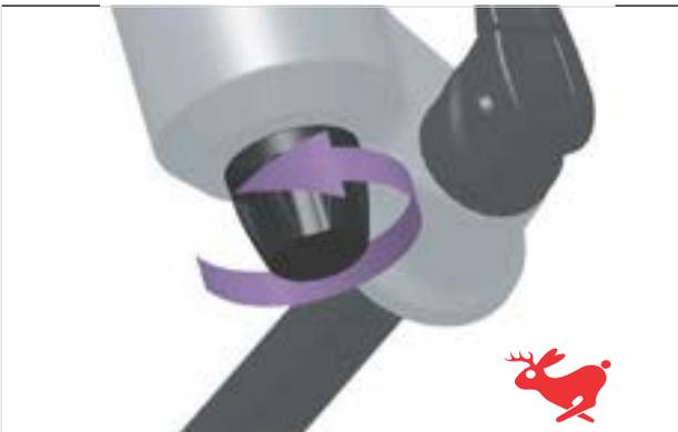
Illustration 312 : Tourner le réglage de la détente (fourche de suspension) vers le lièvre
