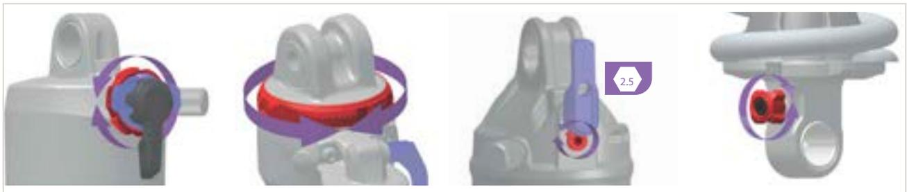
Illustration 324 : La position et la forme du dispositif de réglage de la détente (amortisseur arrière) (rouge) dépendent du modèle
