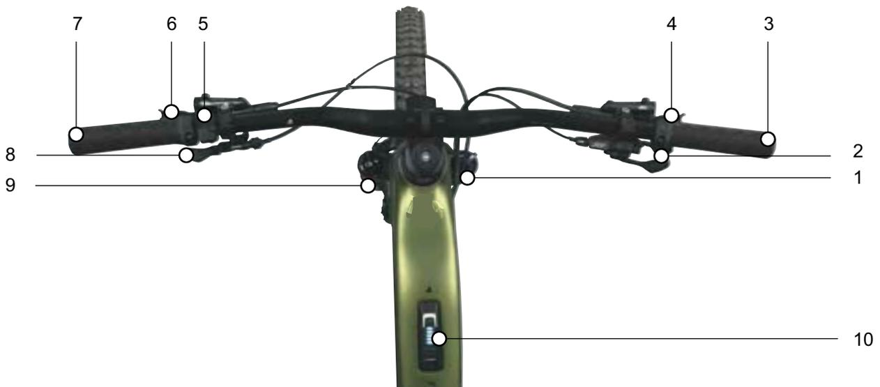
Illustration 60 : Vue détaillée du guidon avec ordinateur de bord BOSCH System Controller et unité de commande Mini Remote, exemple
