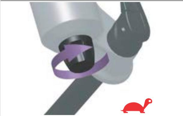
Illustration 310 : Tourner le réglage de la détente (fourche de suspension) vers la tortue
