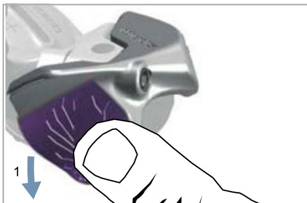
Illustration 165 : Poussez l'interrupteur à bascule vers le bas
