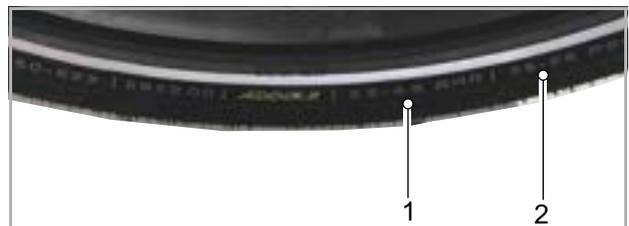
Illustration 212 : Indication de pression des pneus en bar (1) et psi (2)
