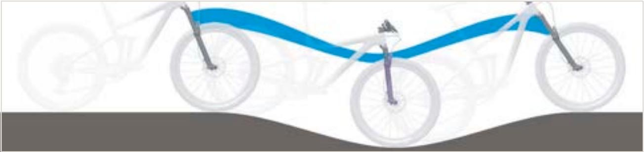
Illustration 313 : Suspension trop souple de la fourche suspendue dans les côtes
