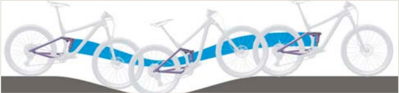
Illustration 327 : Suspension trop souple de l'amortisseur arrière dans les côtes
