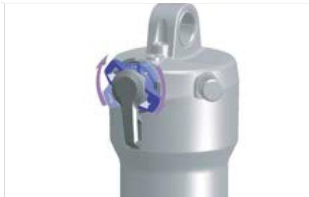
Illustration 186 : Régler le dispositif de réglage de la compression sur un niveau plus dur
