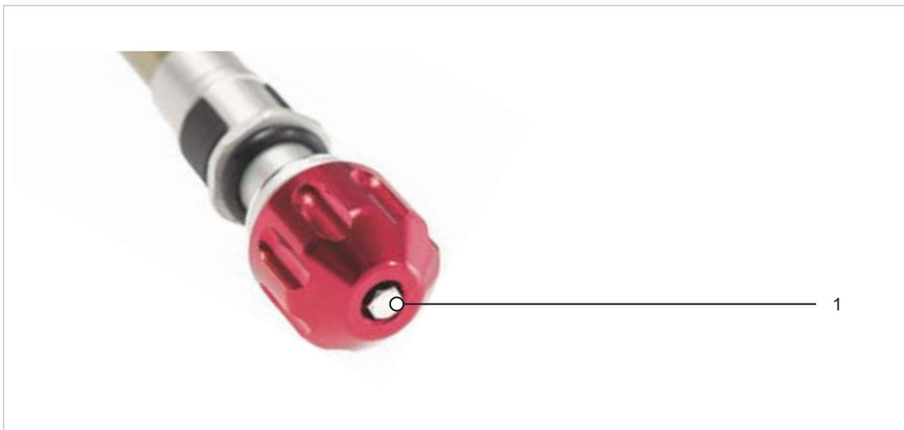
Illustration 175 : Exemple d'un réglage de détente SR SUNTOUR (fourche de suspension) (1)
