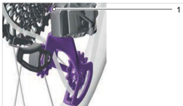
Illustration 156 : Position de la vis de réglage (dérailleur arrière) (1)
