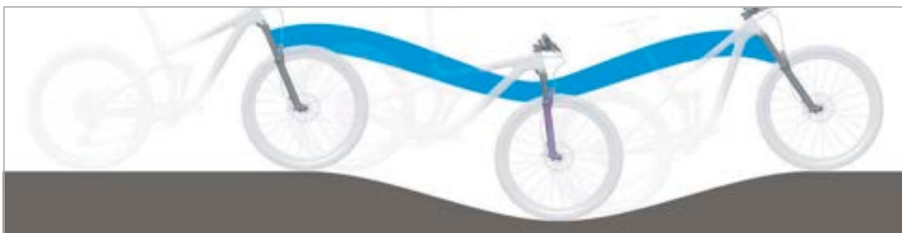
Illustration 22 : Comportement optimal de la fourche de suspension en terrain vallonné
