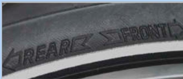
Illustration 87 : Flèche directionnelle sur les pneus VTT
