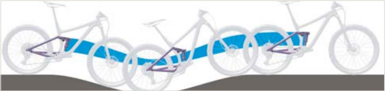
Illustration 335 : Suspension trop souple de l'amortisseur arrière dans les côtes
