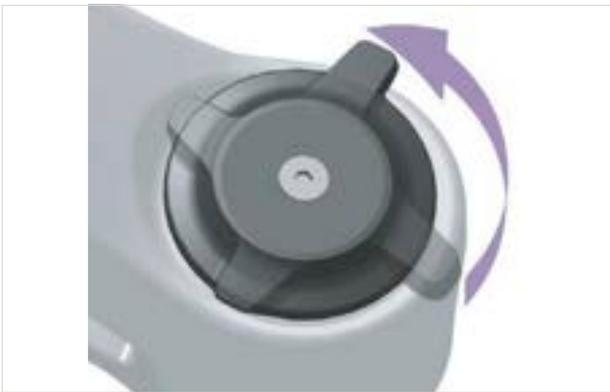
Illustration 316 : Régler le dispositif de réglage de la compression sur un niveau plus souple
