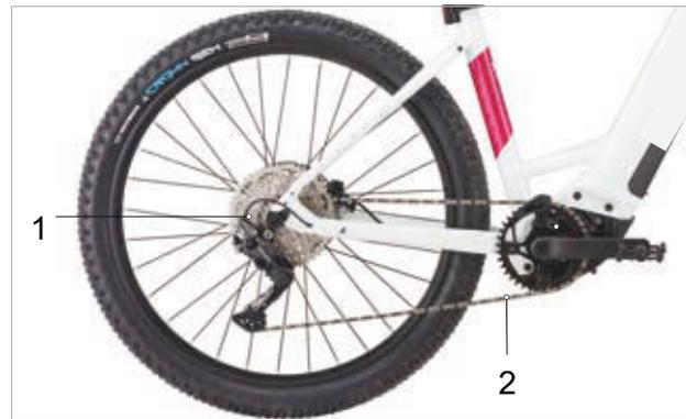
Illustration 50 : Schéma de l'entraînement à chaîne avec dérailleur
