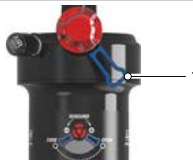
Tableau 55 : Levier de compression (amortisseur arrière) (1) sur amortisseur arrière EDGE plus 2CR
