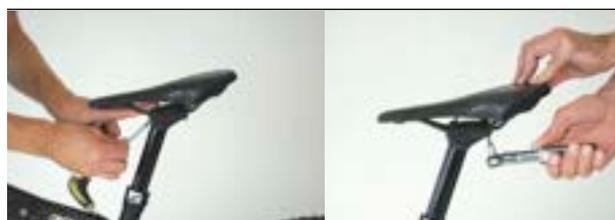
Illustration 129 : Fixer les vis avant et arrière
