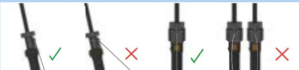
Illustration 273 : Câble Bowden correct et incorrect
