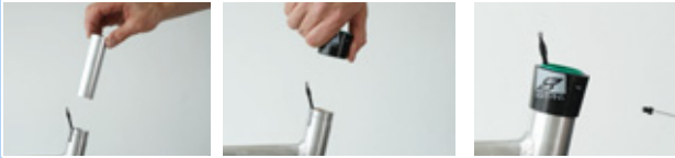
Figura 202: Montaggio del maniccotto scorrevole e della boccola esterna
