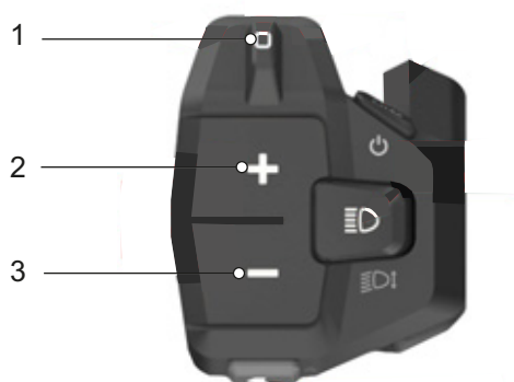
Figura 105: Ubicazione interruttore a bilico (1), pulsante più (2) e pulsante meno (3)
