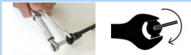
Figura 167: Regolazione in senso orario
