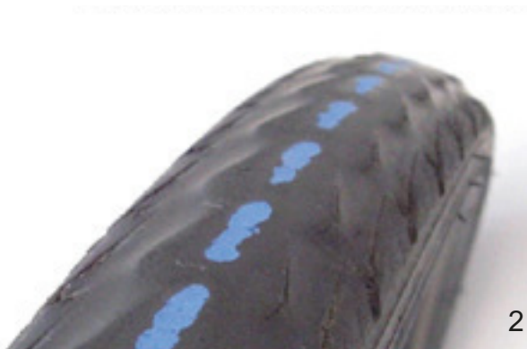
Figura 132: Pneumatico senza profilo ancora utilizzabile (1) e pneumatico con protezione contro le forature in vista (2) che deve essere sostituito
