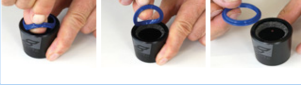
Figura 190: Estrazione del parapolvere
