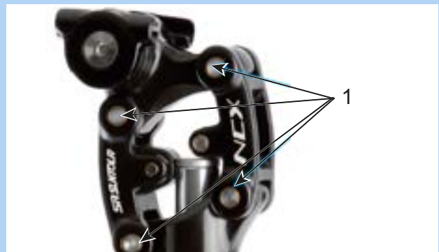
Figura 144: Punti di lubrificazione del cannotto reggisella ammortizzato SR Suntour
