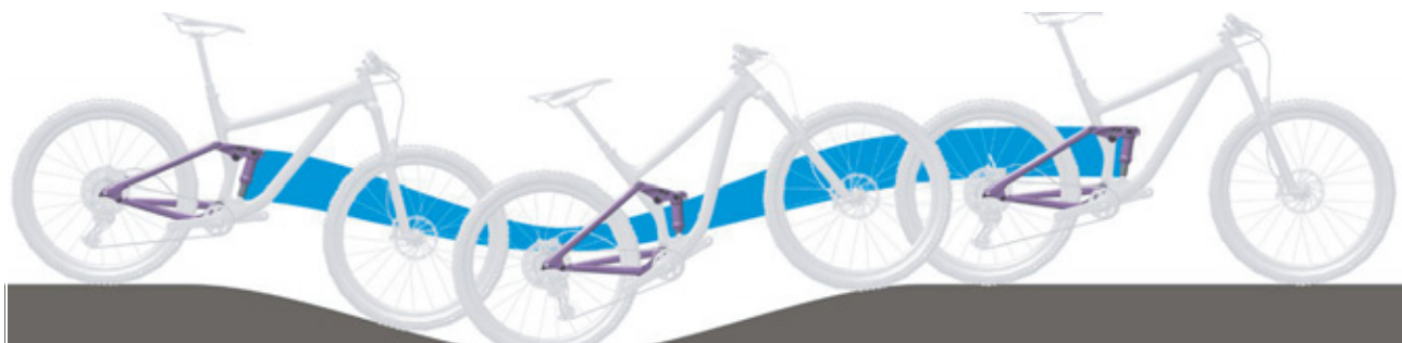
Figura 229: Sospensione dell'ammortizzatore del carro posteriore troppo morbida in salita
