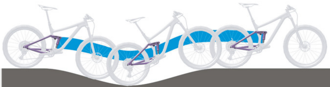
Figura 16: Comportamento di marcia ottimale dell'ammortizzatore del carro posteriore su un terreno con dossi
