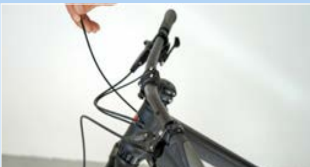
Figura 204: Aggancio del cappuccio terminale
