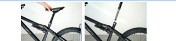
Figura 185: Rimozione del cannotto reggisella
