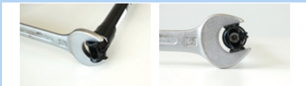
Figura 166: Bloccaggio per impedire la rotazione
