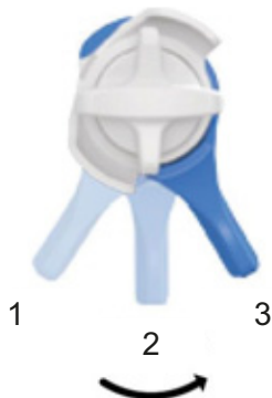
Figura 97: Regolazione della leva a 3 vie da chiusa (1) a media (2) fino ad aperta (3)
