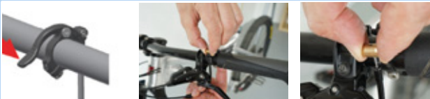
Figura 147: Smontaggio della cartuccia
