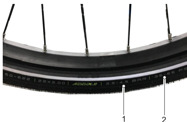
Figura 131: Pressione di gonfiaggio in bar (1) e in psi (2)
