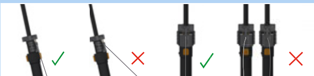
Figura 172: Cavo meccanico corretto ed errato
