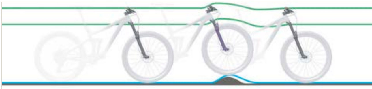
Obr. 253: Příliš tvrdé tlumení odpružené vidlice u nerovnosti
