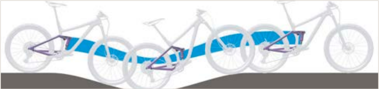
Obr. 268: Příliš měkké odpružení tlumiče zadního odpružení v horách
