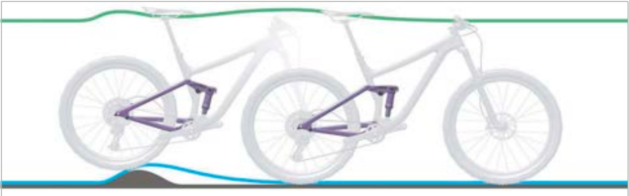
Obr. 262: Příliš tvrdé tlumení tlumiče zadního odpružení u nerovnosti
