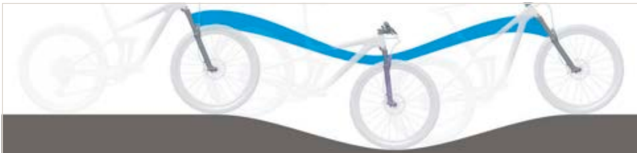
Obr. 250: Příliš měkké odpružení odpružené vidlice v horách
