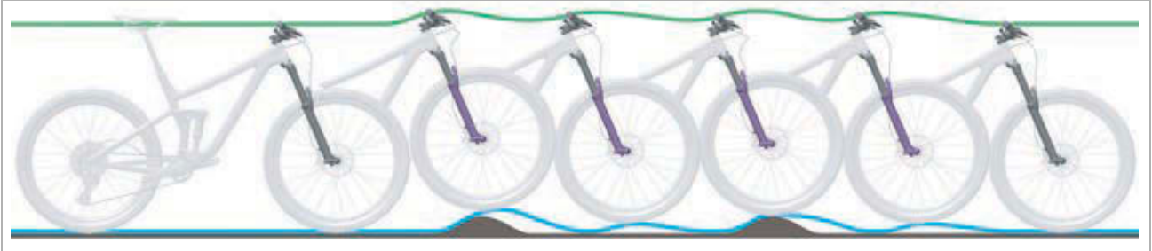
Obr. 240: Příliš rychlé roztahování odpružené vidlice
