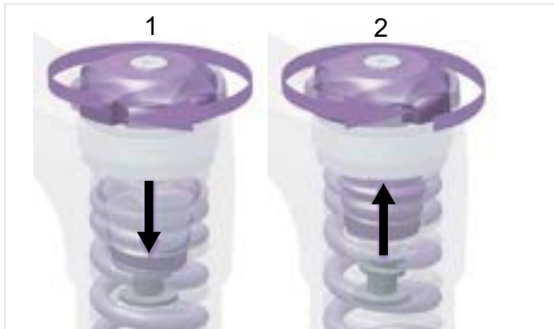
Obr. 131: Otáčení nastavovacího kolečka SAG dovnitř (1) a ven (2)
