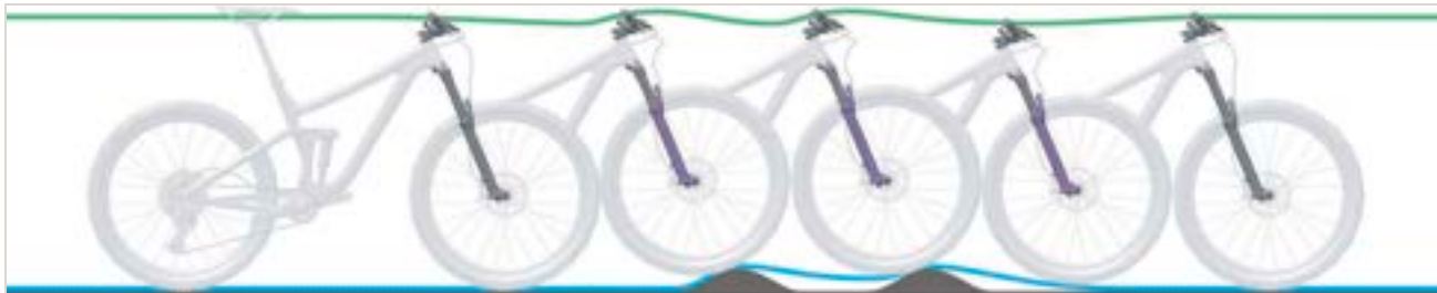
Obr. 248: Příliš pomalé roztahování odpružené vidlice
