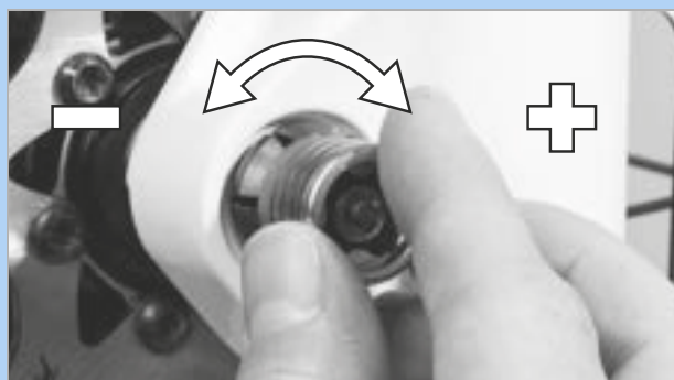
Obr. 86: Nastavení upínací síly
