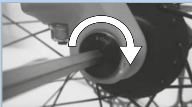
Obr. 75: Utažení osy ve směru šipky
