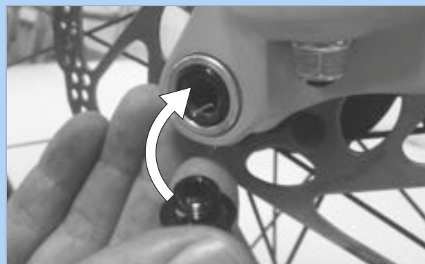
Obr. 76: Nasazení pojistného šroubu
