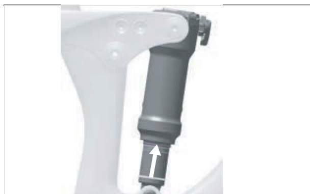
Obr. 144: Posunutí O-kroužku na tlumiči zadního odpružení
