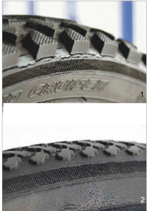
Obr. 199: Příklady únavových trhlin (1) a trhlin vzniklých stárnutím (2)
