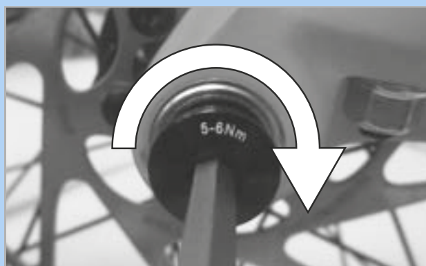
Obr. 77: Utažení pojistného šroubu
