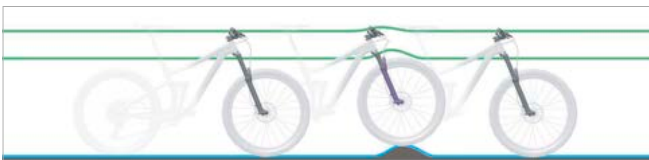
Obr. 17: Optimální chování vidlice při jízdě u nerovností
