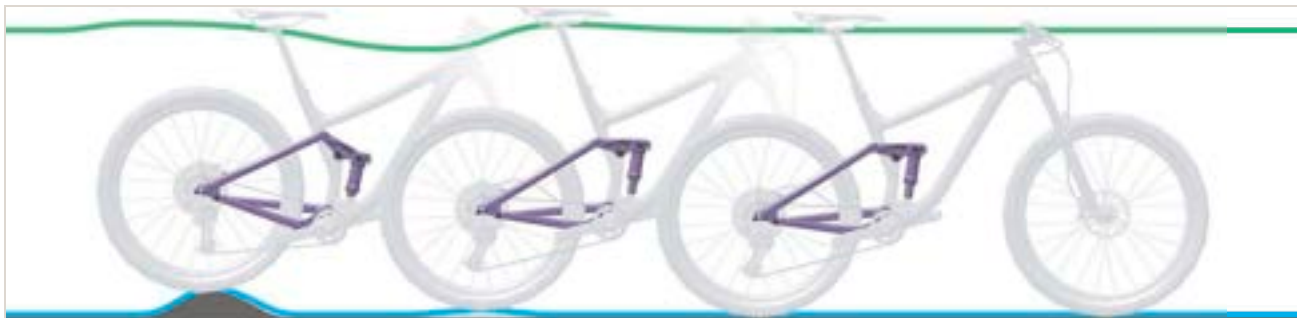
Obr. 272: Příliš rychlé roztahování tlumiče zadního odpružení
