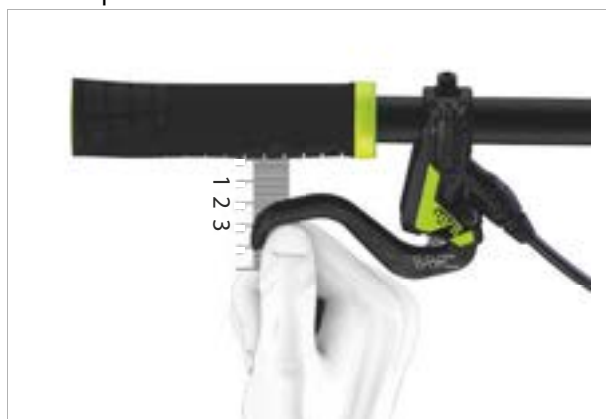
Obr. 124: Polohování ruční brzdy
