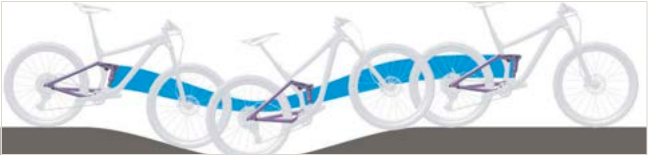
Obr. 260: Příliš měkké odpružení tlumiče zadního odpružení v horách
