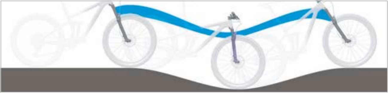
Obr. 244: Příliš měkké odpružení odpružené vidlice v horách
