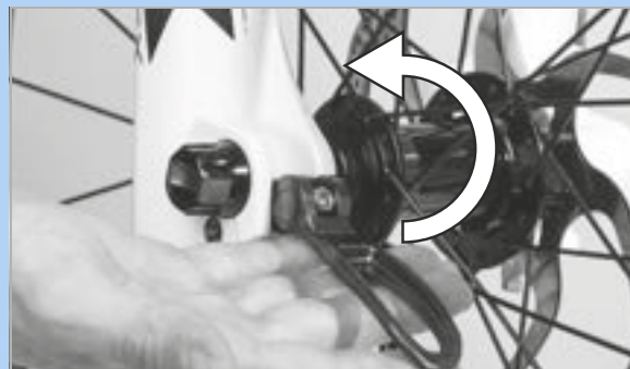
Obr. 81: Stlačte páku rychloupínáku ve směru šipky
