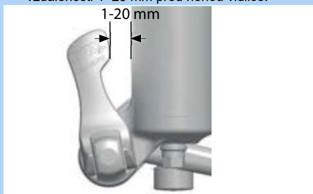
Obr. 89: Vzdálenost páky od nohy vidlice
