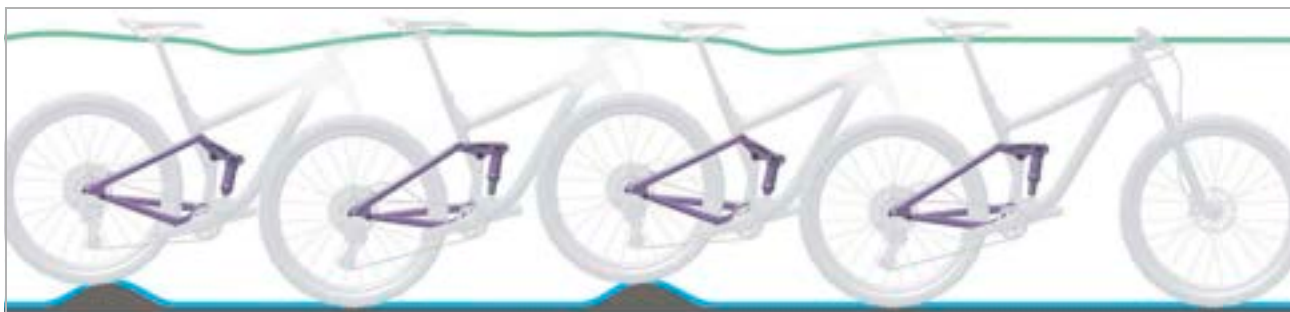
Obr. 151: Optimální chování tlumiče zadního odpružení při jízdě
