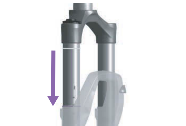
Obr. 132: Posunutí O-kroužku odpružené vidlice
