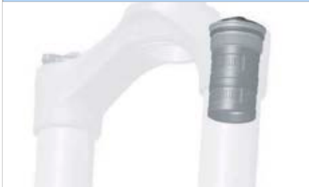
Obr. 137: Dva Bottomless Tokens v odpružení DebonAir
