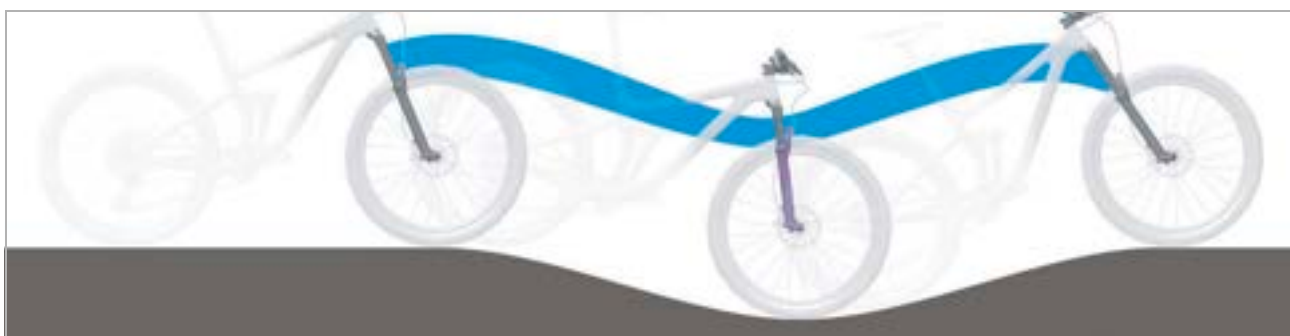
Obr. 16: Optimální chování vidlice při jízdě v kopcovitém terénu
