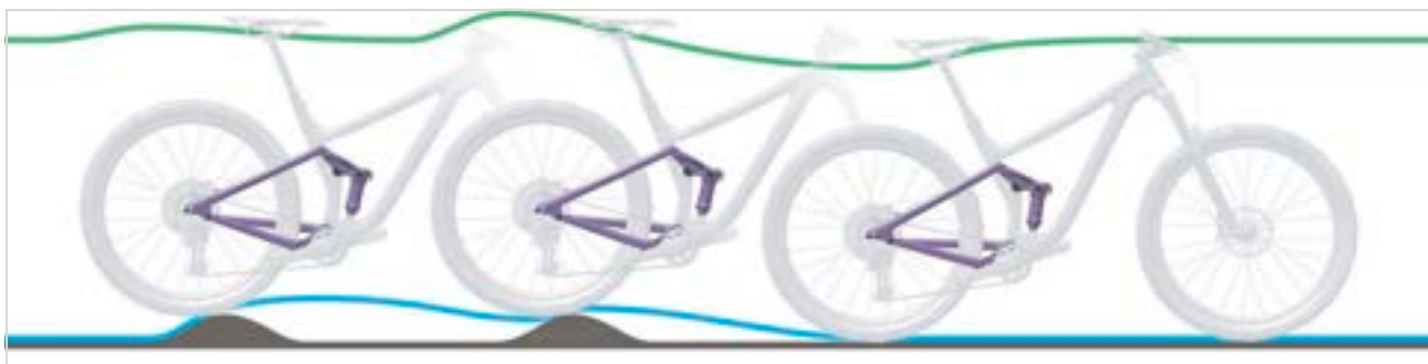
Obr. 266: Příliš pomalé roztahování tlumiče zadního odpružení
