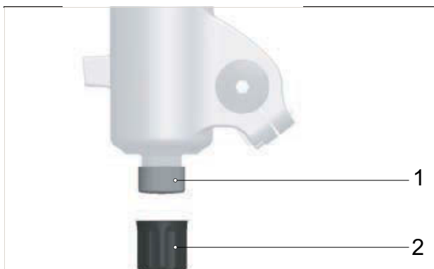
Obr. 249: Nastavovací šroub odskoku FOX (vidlice) (1) pod krytkou vidlice (2)
