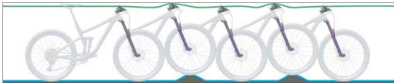
Obr. 128: Optimální chování vidlice při jízdě
