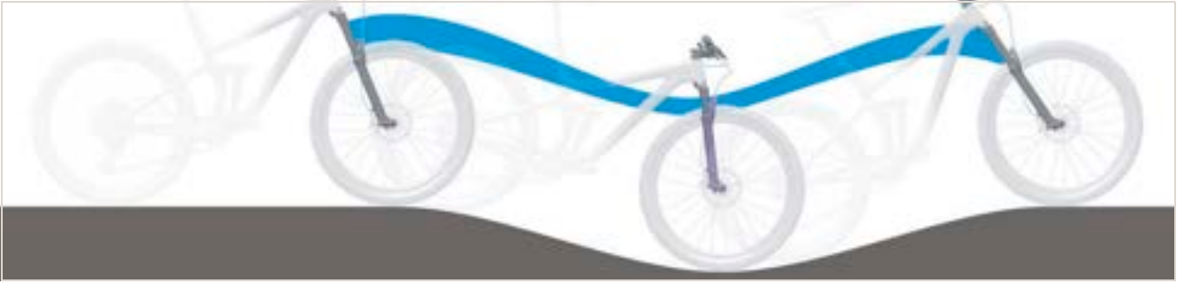
Obr. 236: Příliš měkké odpružení odpružené vidlice v horách
