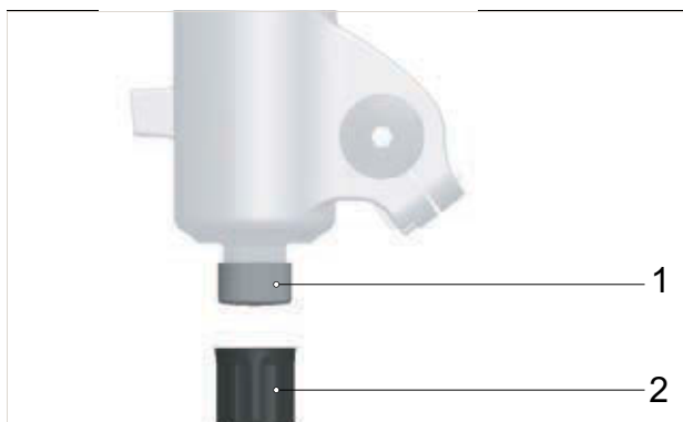
Obr. 150: Nastavovací šroub odskoku FOX (vidlice) (1) pod krytkou vidlice (2)
