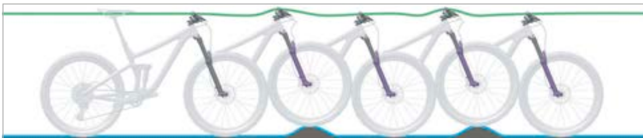
Obr. 18: Optimální chování vidlice při jízdě
