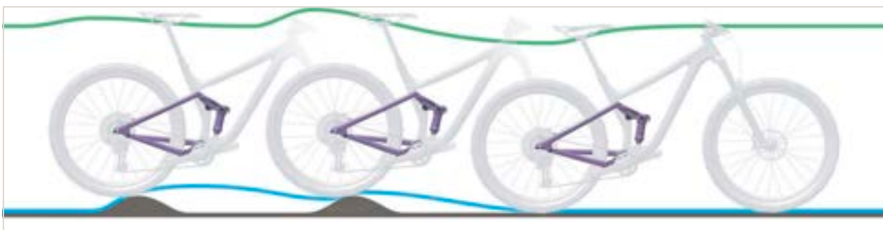
Obr. 258: Příliš pomalé roztahování tlumiče zadního odpružení
