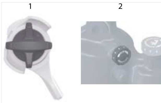
Obr. 267: Nastavovací šroub odskoku Float DPS (1) a Float X (2)
