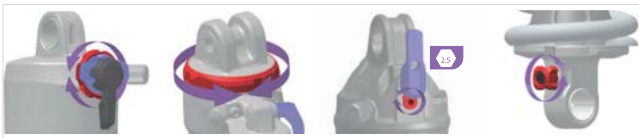
Obr. 273: Poloha a tvar nastavovacího šroubu odskoku (tlumič zadního odpružení) (červený) jsou závislé na modelu
