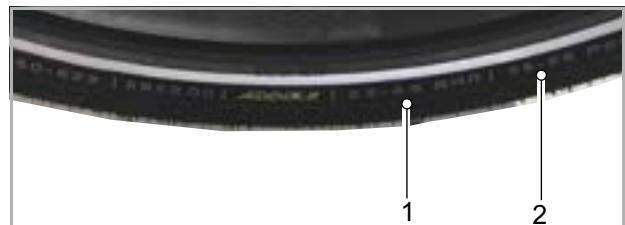
Obr. 197: Údaj tlaku v barech (1) a psi (2)
