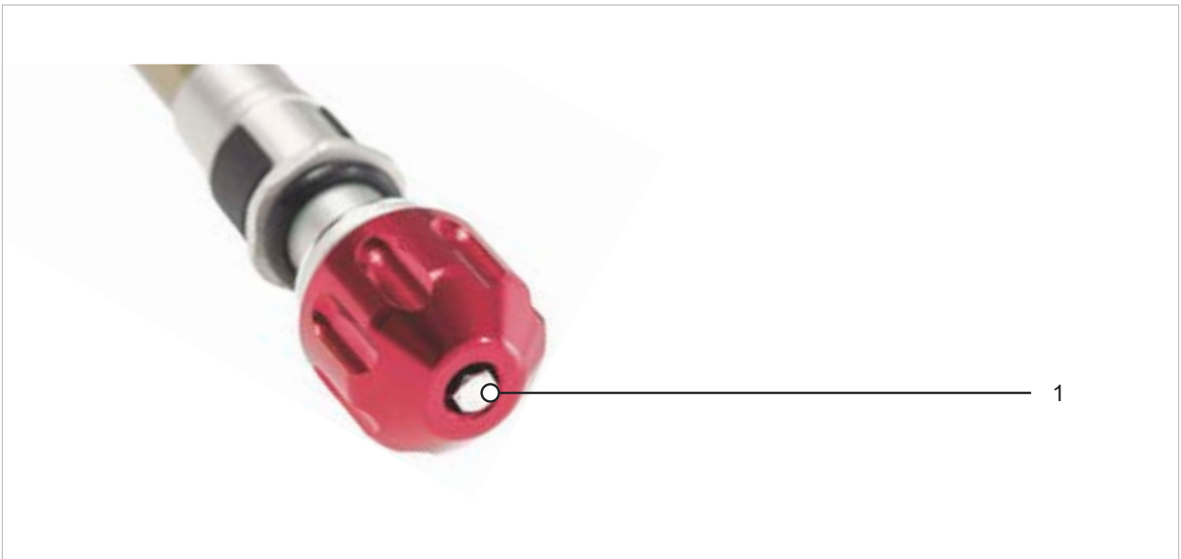
Obr. 241: Příklad nastavovacího šroubu odskoku (vidlice) SR SUNTOUR (1)
