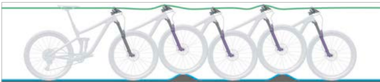
Obr. 15: Optimální chování vidlice při jízdě
