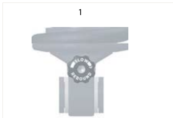
Obr. 155: Nastavovací šroub odskoku Float DHX (1)
