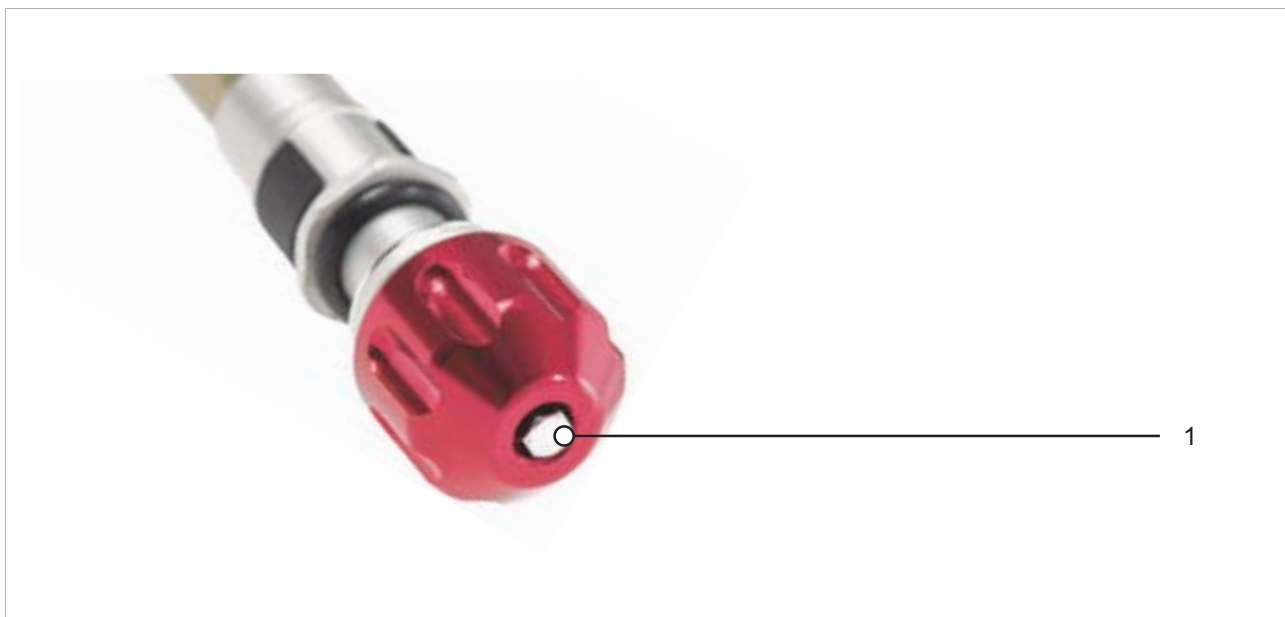
Obr. 148: Příklad nastavovacího šroubu odskoku (vidlice) SR SUNTOUR (1)
