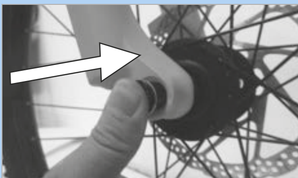
Obr. 74: Zasunutí osy ve směru šipky
