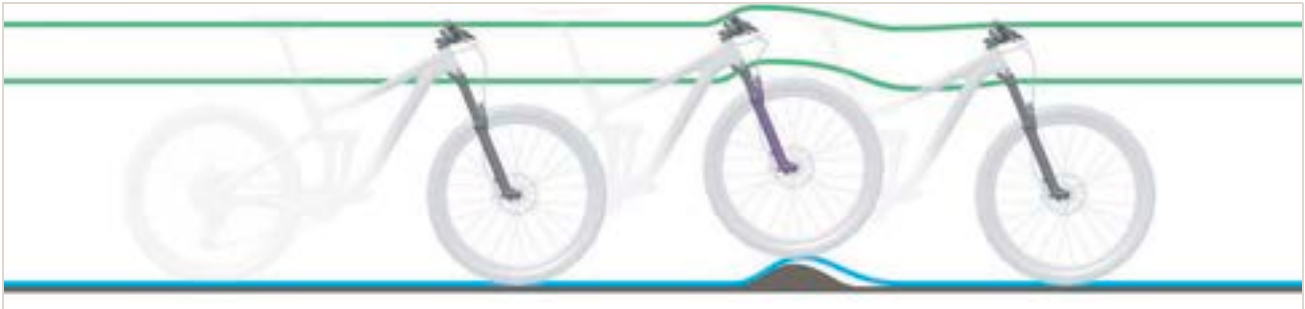
Obr. 238: Příliš tvrdé tlumení odpružené vidlice u nerovností
