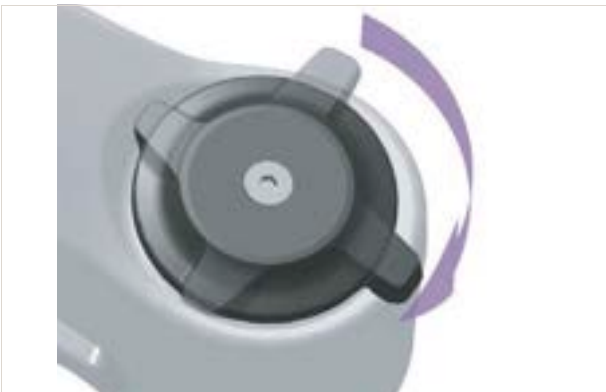
Obr. 237: Tvrdší nastavení nastavovacím šroubem komprese
