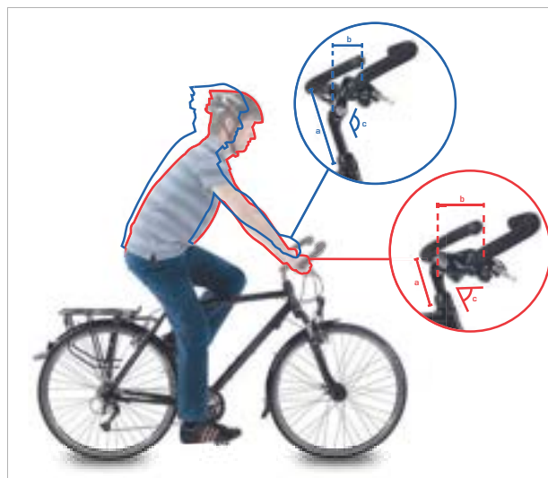
Obr. 117: Poloha u městského (modrá) a trekingového kola (červená) při změně úhlu
