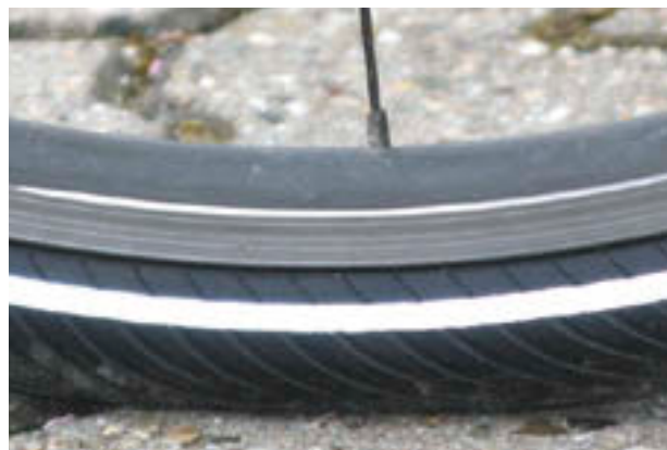
Obr. 119: Správný tlak. Plášt' se působením hmotnosti těla téměř nezdeformuje
