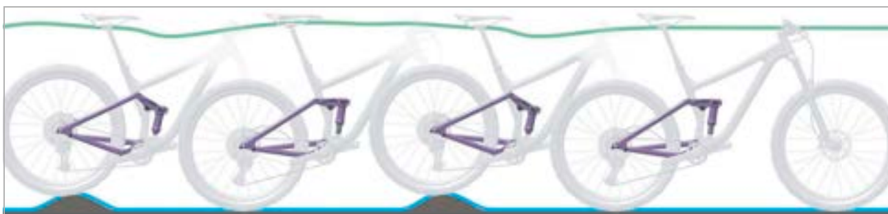
Obr. 5: Optimální chování tlumiče zadního odpružení při jízdě
