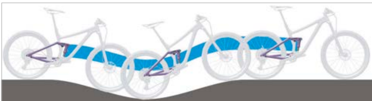
Obr. 6: Optimální chování tlumiče zadního odpružení při jízdě v kopcovitém terénu
