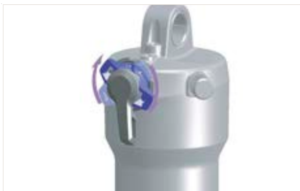
Obr. 175: Tvrdší nastavení nastavovacím šroubem komprese
