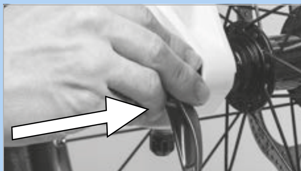
Obr. 85: Zasunutí rychloupínáku ve směru šipky
