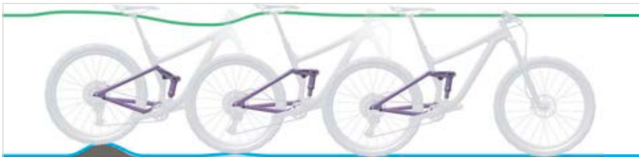
Obr. 264: Příliš rychlé roztahování tlumiče zadního odpružení
