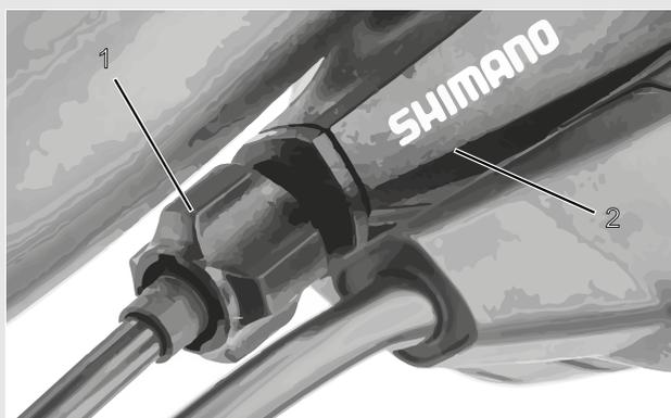
Figura 87: Boccola di regolazione (1) del cambio azionato da cavo singolo con scatola della leva del cambio (2), esempio
