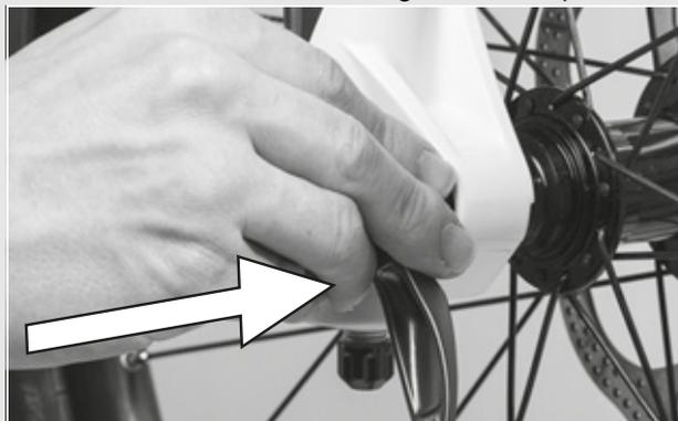
Figura 39: Inserimento del bloccaggio rapido
