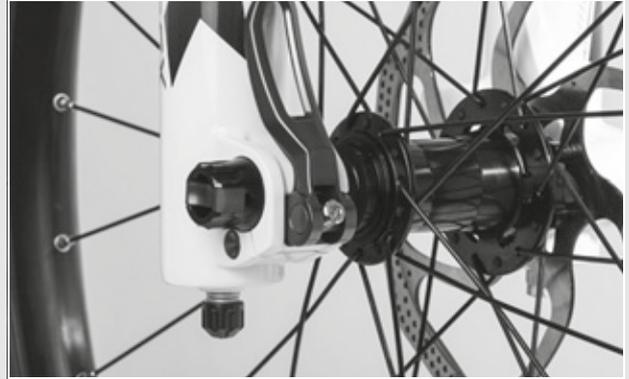
Figura 36: Corretta posizione della leva di serraggio
