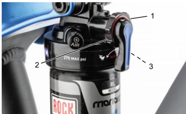
Figura 80: Regolazione della rigidità dell'ammortizzatore a stadi di trazione con la manopola di regolazione (1) dell'ammortizzatore del carro posteriore
