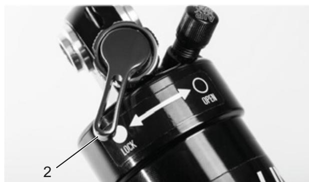
Figura 76: Regolatore dello stadio di pressione Suntour chiuso (2)
