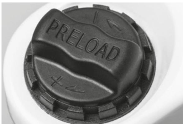
Figura 58: Manopola di regolazione dell'escursione negativa della sospensione sulla corona della forcella ammortizzata
