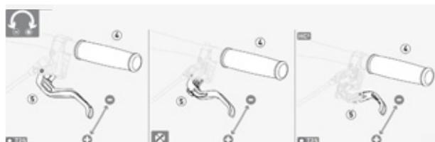
Figura 56: Regolazione dell'ampiezza di presa della leva del freno Magura con freno a disco
