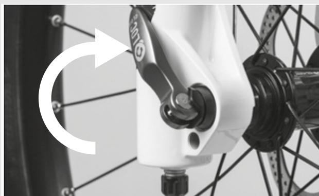
Figura 41: Chiusura del bloccaggio rapido
