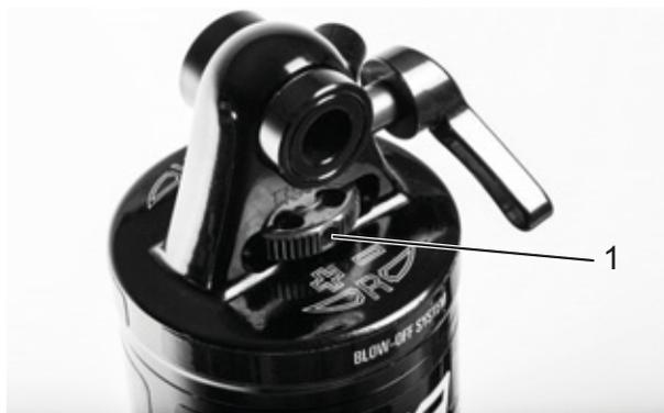
Figura 62: Regolatore del rebound Suntour (1) sull'ammortizzatore del carro posteriore
