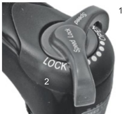
Figura 74: Regolatore dello stadio di pressione Suntour con posizioni OPEN (1) e LOCK (2)
